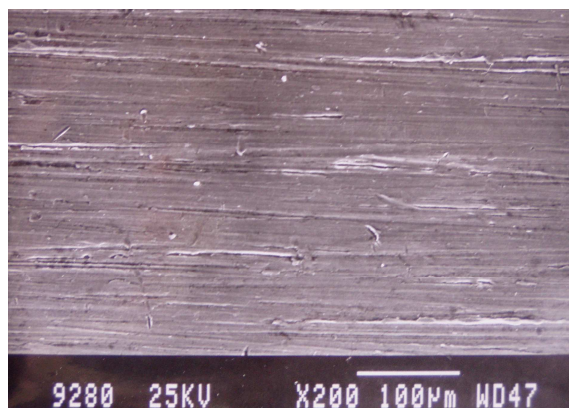
Povrch vzorku po leštění Počet cyklů 2,174.800; \sigma_0 = 475\text{MPa}
