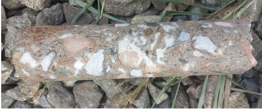
Obrázek 51: Jádrový vývrt ihned po odebrání z konstrukce
