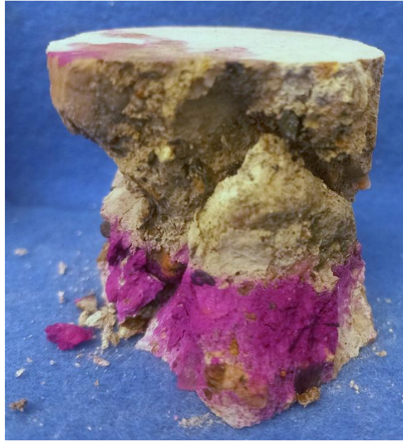
Obrázek 75: Vzorek s největší zjištěnou hloubkou karbonatace V8-1
