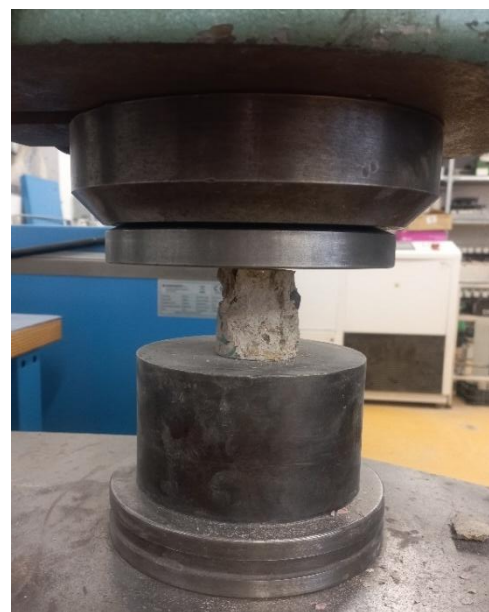
Obrázek 72: Porušení vzorku V6-1-B po zkoušce pevnosti v tlaku ve zkušebním lisu
