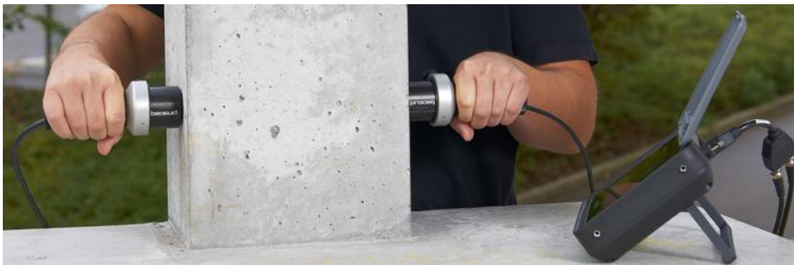
Obrázek 6: Ukázka přímého prozvučování UZ přístrojem [33]
