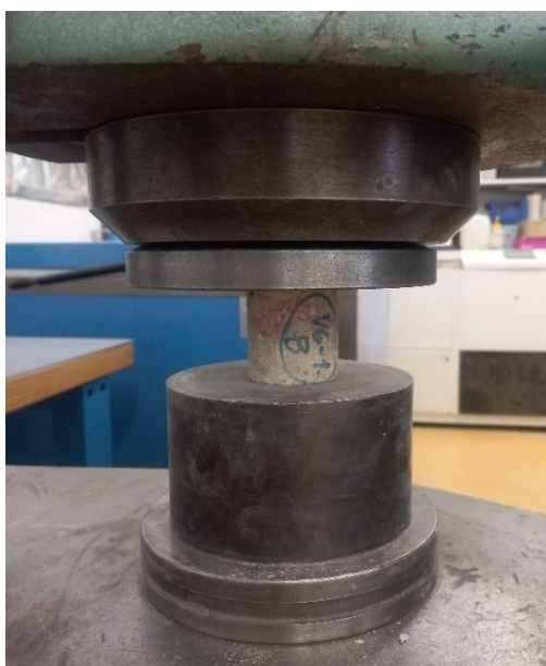
Obrázek 71: Zkušební vzorek V6-1-B uchycený ve zkušebním lisu před tlakovou zkouškou
