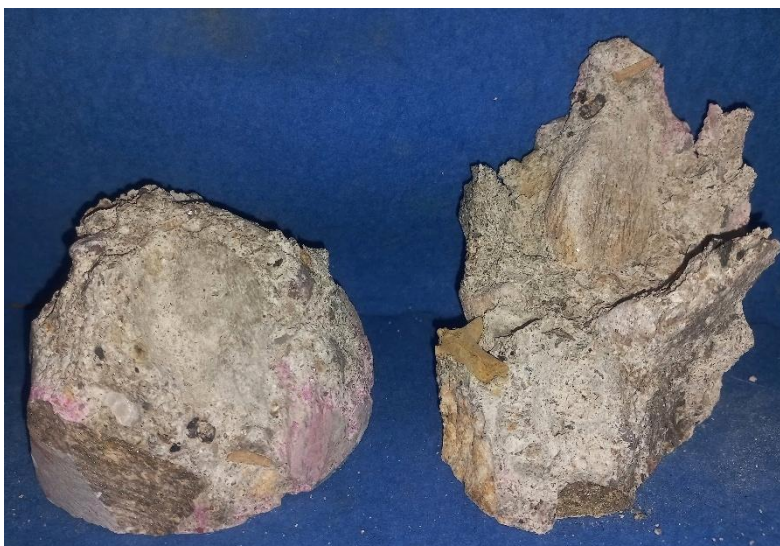
Obrázek 73: Porušený vzorek s patrným zrnem většího kameniva a organickým materiálem (dřevěná větvička)
