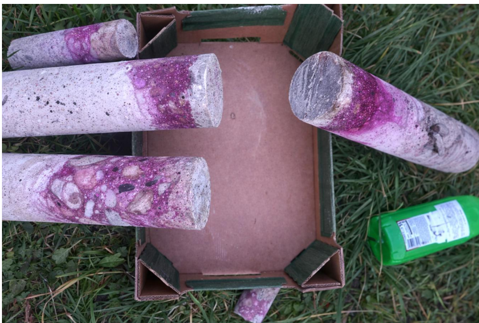
Obrázek 59: Zkouška hloubky karbonátace in situ pomocí fenolftaleinu
