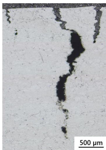
Obrázok 102 Pozorovanie šírenia trhliny vzorky s označením 6.1. s nástrekom Fe, leptané
