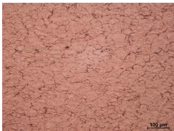
Obrázok 86 Detail štruktúry Cu vzorky s označením 8.1.5. Cu, leptané, východiskový stav
