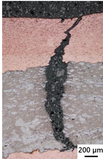
Obrázok 91 Pozorovanie šírenia trhliny vzorky s označením 2.6. Cu-Fe-Cu, leptané
