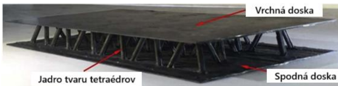
Obrázok 37 Schematický popis sendvičového kompozitu s prepojením vonkajších plášťov výstužami do tvaru tetraédrov, upravené a prevzaté z [86]
