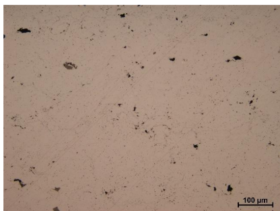
Obrázok 82 Mikroštruktúra vzorky Fe nástreku s označením 5.7., neleptané, východiskový stav
