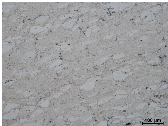
Obrázok 84 Detail štruktúry Fe vzorky s označením 2.6. Cu-Fe-Cu, leptané, východiskový stav
