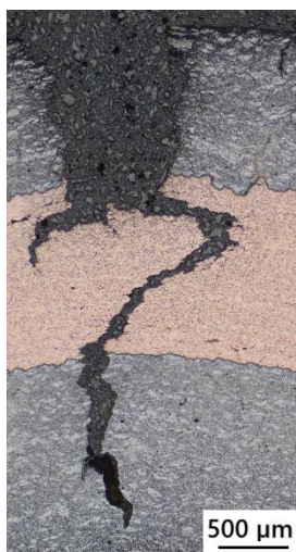
Obrázok 100 Pozorovanie šírenia trhliny vzorky s označením 3.1. s nástrekom Fe-Cu-Fe, leptané
