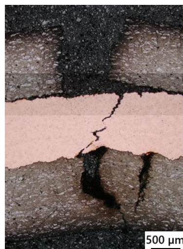
Obrázok 93 Pozorovanie šírenia trhliny vzorky s označením 4.6. Fe-Cu-Fe, leptané
