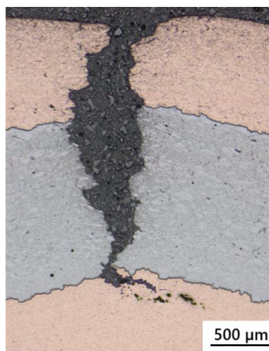
Obrázok 98 Pozorovanie šírenia trhliny vzorky s označením 1.2. s nástrekom Cu-Fe-Cu, leptané
