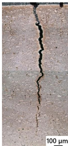
Obrázok 95 Pozorovanie šírenia trhliny vzorky s označením 5.7. Fe, leptané
