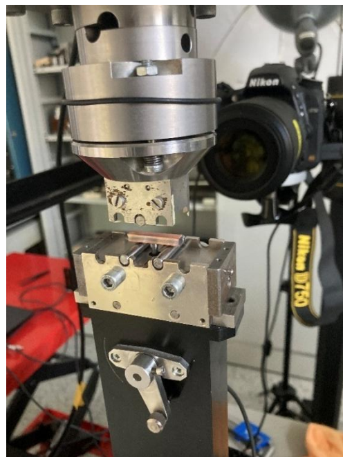
Obrázok 80 Experimentálny DIC setup – skúška trojbodovým ohybom (vľavo), vzorka nástreku vrstiev Cu-Fe-Cu položená na podpory (vpravo)
