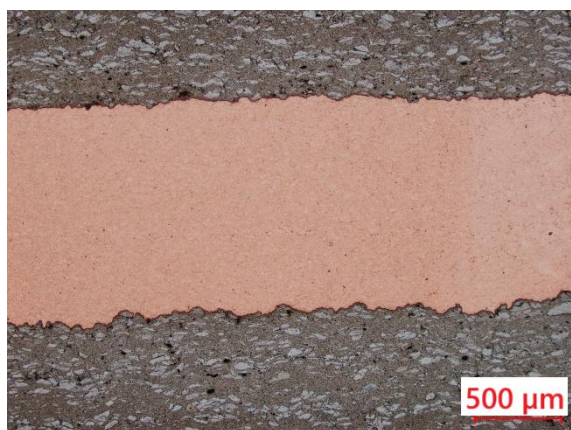
Obrázok 88 Rozhranie nástrekov Fe - Cu vzorky 4.6. Fe-Cu-Fe, východiskový stav
