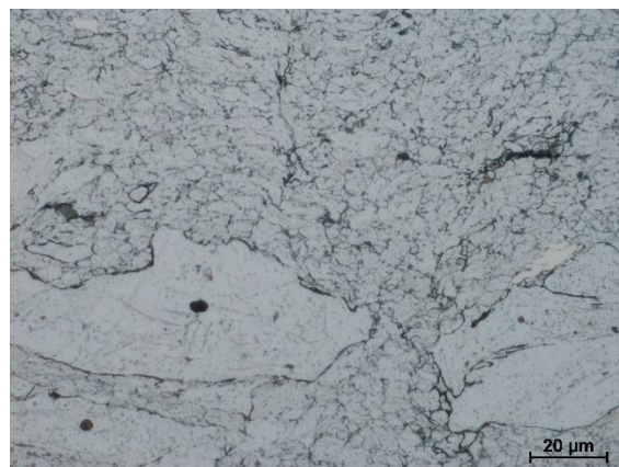
Obrázok 85 Detail štruktúry Fe vzorky s označením 4.6. Fe-Cu-Fe, leptané (detail), východiskový stav
