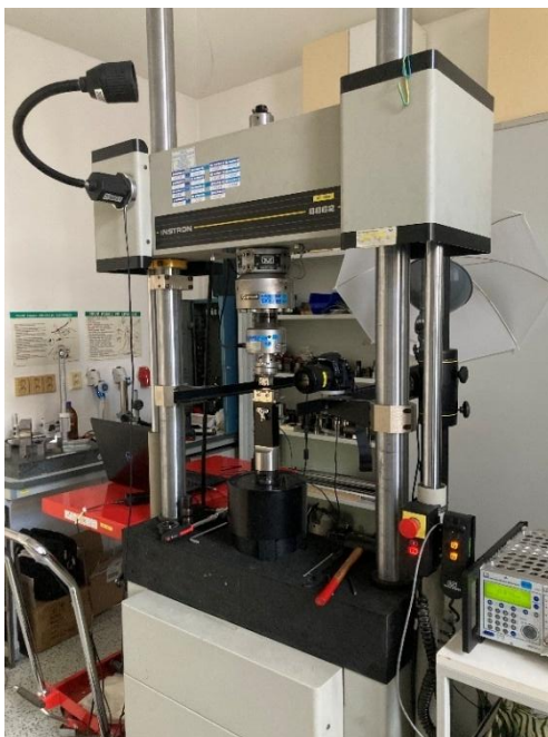
Obrázok 80 Experimentálny DIC setup – skúška trojbodovým ohybom (vľavo), vzorka nástreku vrstiev Cu-Fe-Cu položená na podpory (vpravo)
