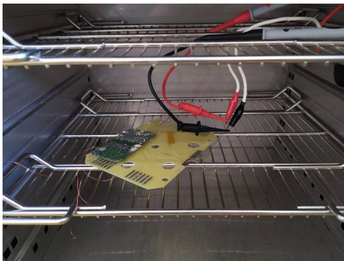
Obr. 3-18 Připojení měřících svorek k DPS uvnitř Teplotní skříně Friocell 55R
