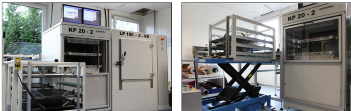
Obr. 2-11 Dvouetážový vysokoteplotní lis LP 100-2-VK s vakuovou komorou[18]
