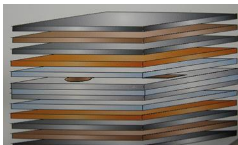
Obr. 2-5 Lay-up – sesouhlasení desek s proloženým prepregem a měděnou fólií [1]
