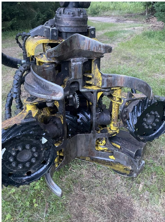
Obr. 10 Odkorňovací hlavice harvestoru [19].
