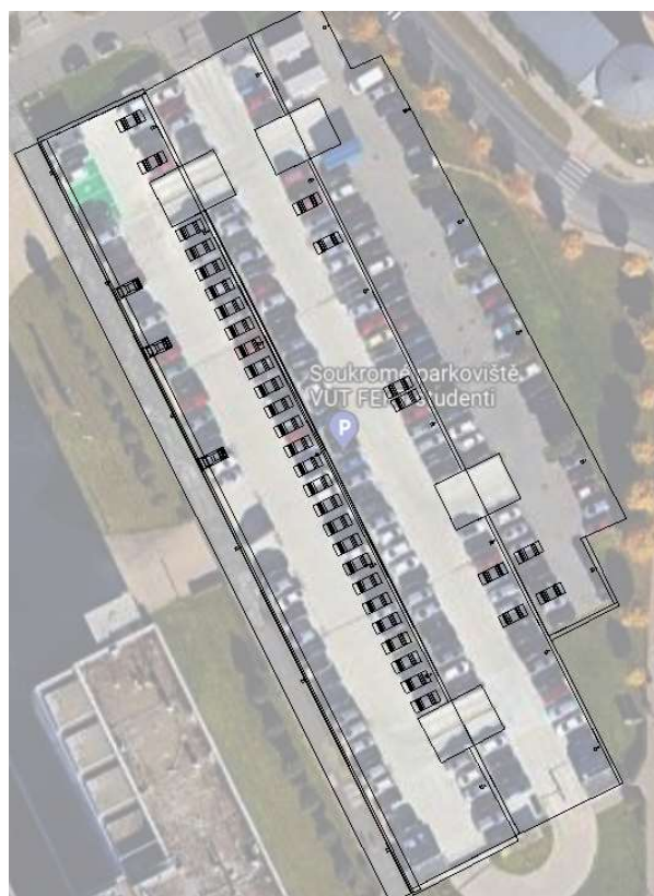
Obrázek 4.3 Modelování parkoviště budovy T12 v programu DIALux [13].
