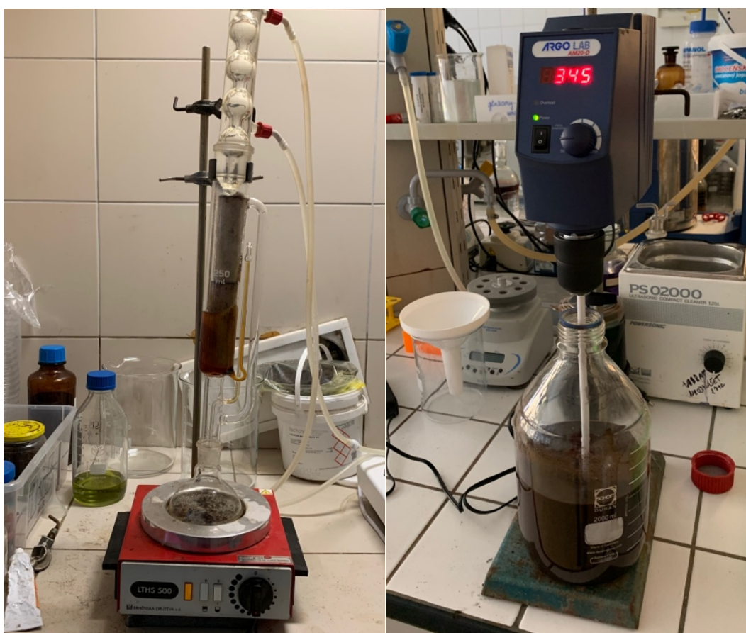
Obrázek 13: Soxhletova aparatura pro extrakci oleje a míchací aparatura pro přípravu kávového hydrolyzátu
