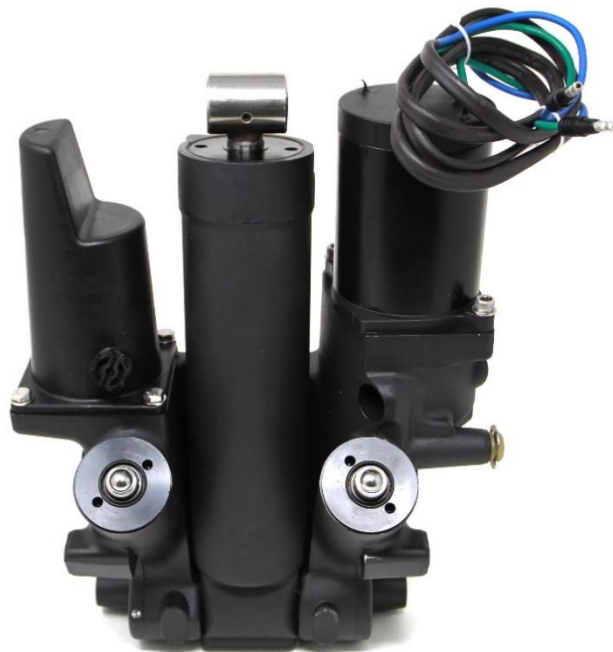
Obr. 10 – Power trim & tilt systém pro značku Mercury [9]
