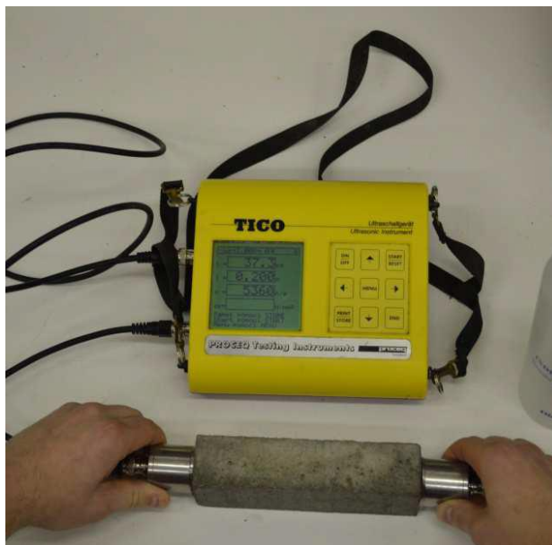
Obrázek 8: Měření ultrazvukovou impulsovou metodou
