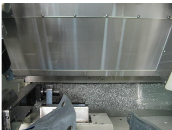
Obr. 7.1 Odpadový prostor stroje.
