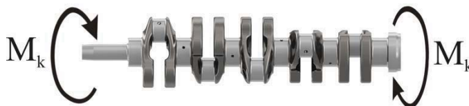
Obr. 6.3 Schéma torzného kmitania kl'ukového hriadeľa
