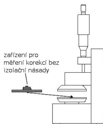
Obr. 28: Princip měření korekcí Short [1]
