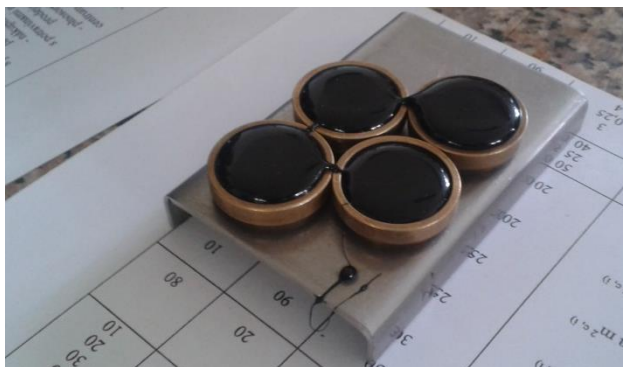
Obrázek 7: Nalité kroužky pro měření bodu měknutí
