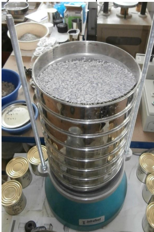
Obrázek 4: Sestava zkušebních sít na vibračním zařízení
