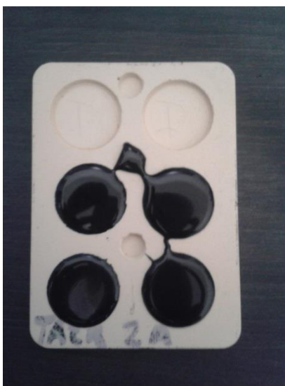
Obrázek 8: Nalité kapky pro měření reologických vlastností
