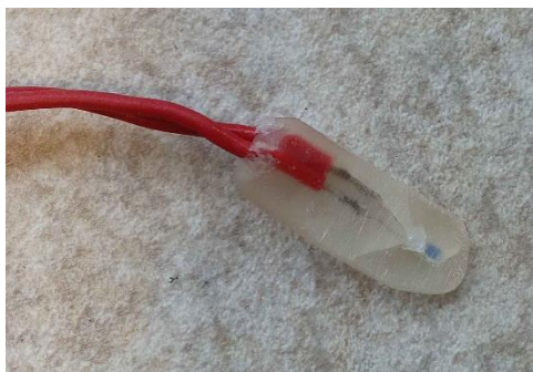
Obrázek 4.25 Popraskané epoxidové pouzdro teplotního čidla vlivem teploty
