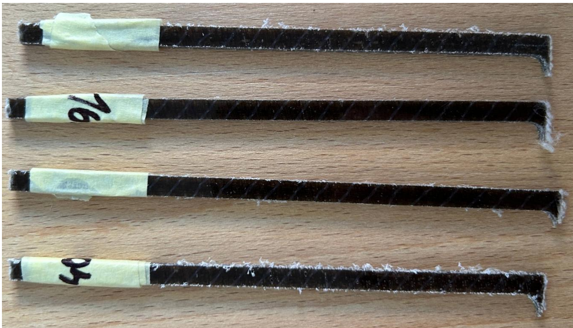
Obr. 58 Otřepy vzorků při frézování za stejných řezných podmínek – měření č. 4, 16, 28, 40.
