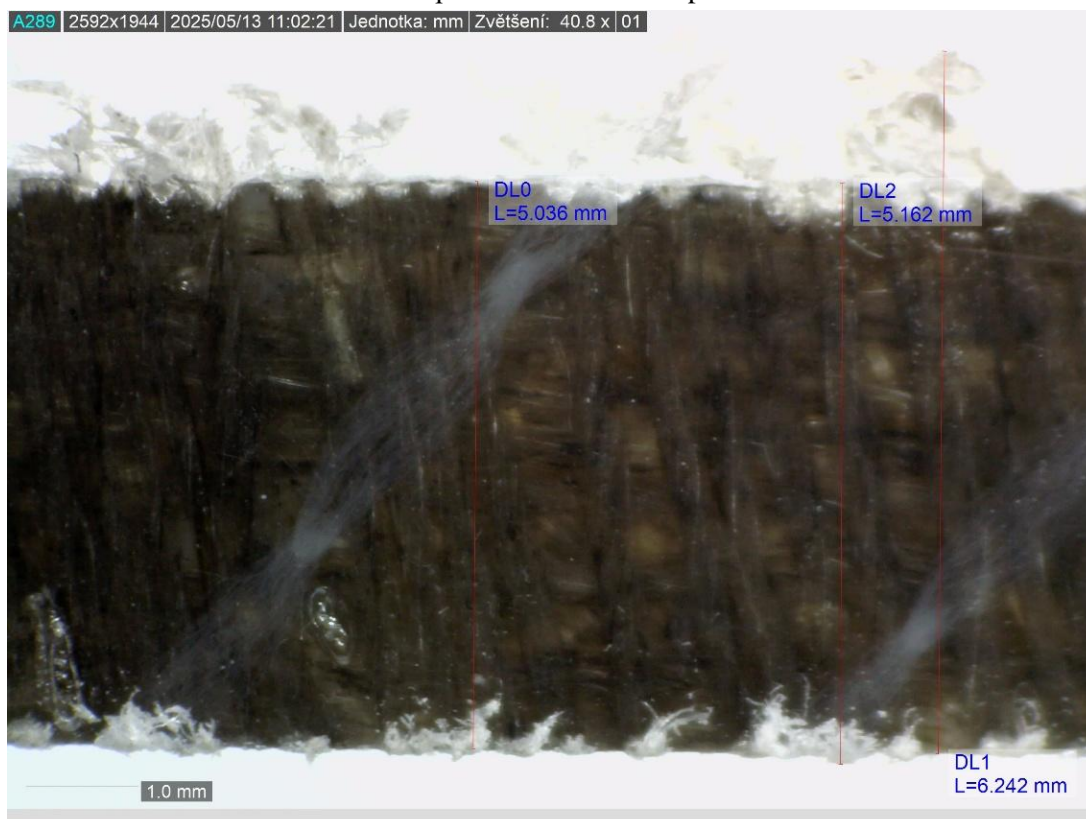
Obr. 56 Určení velikosti šířky vzorku a otřepu v programu DinoCapture 2.0 – měření č. 7.
