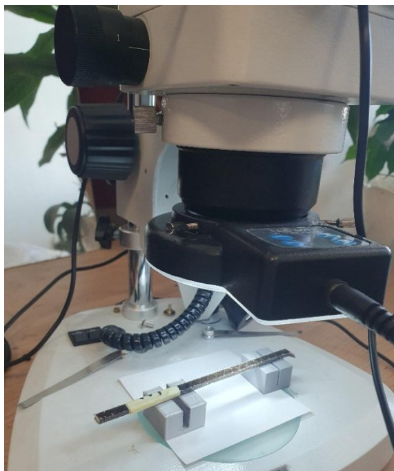
Obr. 55 Měření otřepů na stereomikroskopu Schut SSM-3E.
