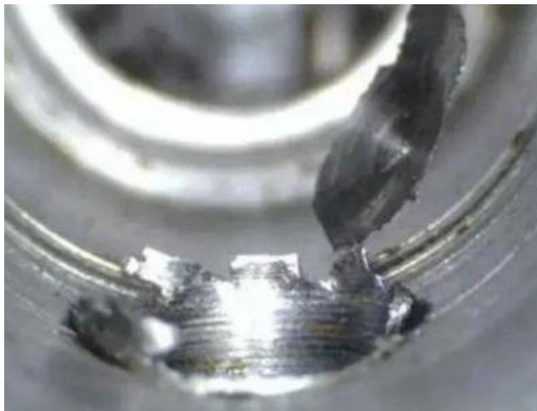
Obr. 16 Otřepy na součásti z oceli po vrtání [33].
