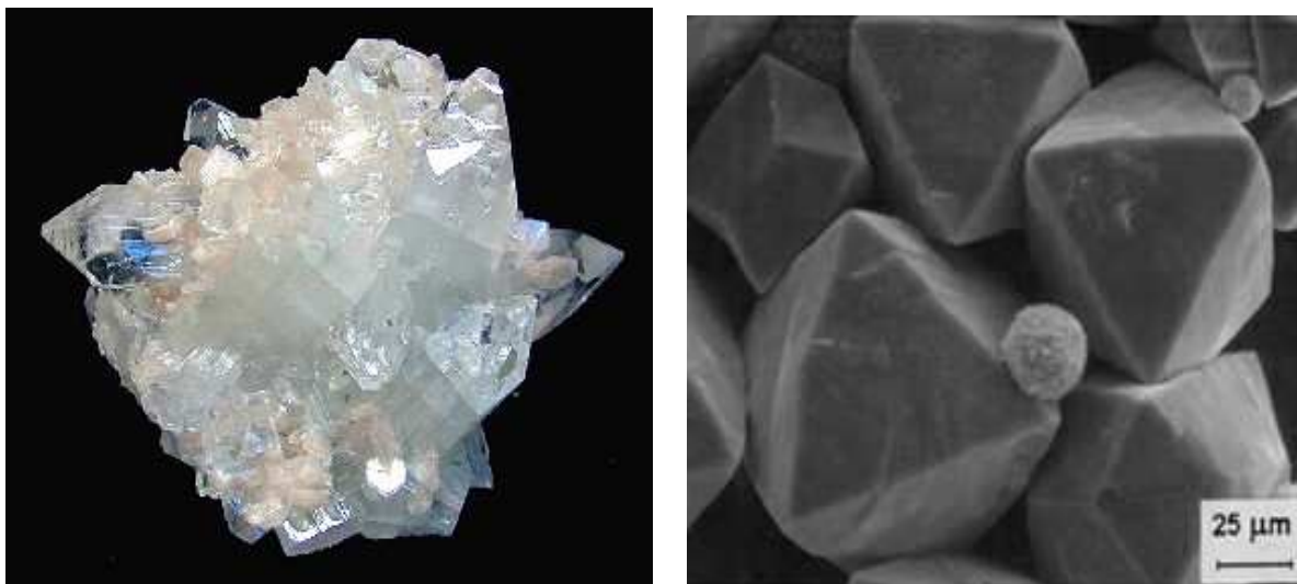
Obr. 3.4. Zeolity makroskopicky (nahore) a mikroskopicky (elektronový mikroskop)
