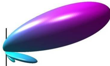
Obr. 2.1: Vizualizace prostorové úzce směrové charakteristiky systému s beamformingem (beamformeru), převzato z [13]
