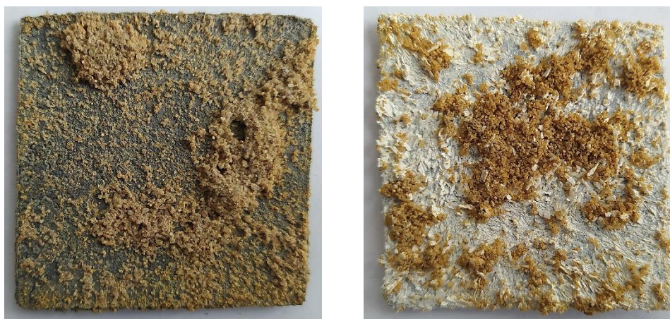
Obrázek 18: Modelové vzorky korodované v prostředí kyseliny mravenčí a písku (vlevo) a kyseliny octové a písku (vpravo).
