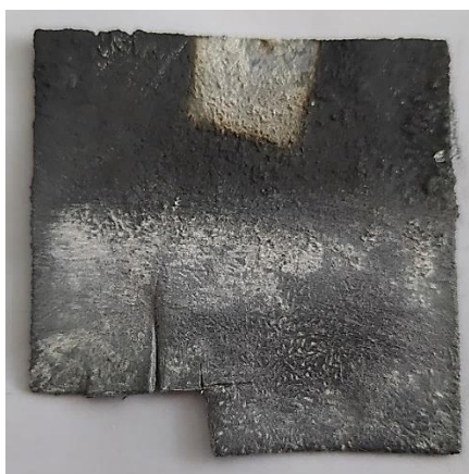
Obrázek 19: Modelový vzorek olova zkorodovaný v kyselině mravenčí a písku, horní ošetřená neočištěná část, spodní ošetřená očištěná část, po odštížení vzorku pro analýzu EDX.
