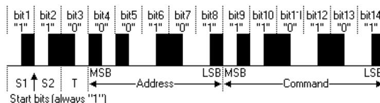
Obrázek 2.5: Datový rámeček RC-5 protokolu [28]
