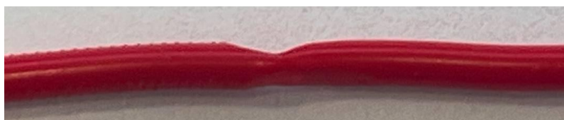
Obrázek 36: Ožvýkaný filament z extruderu
