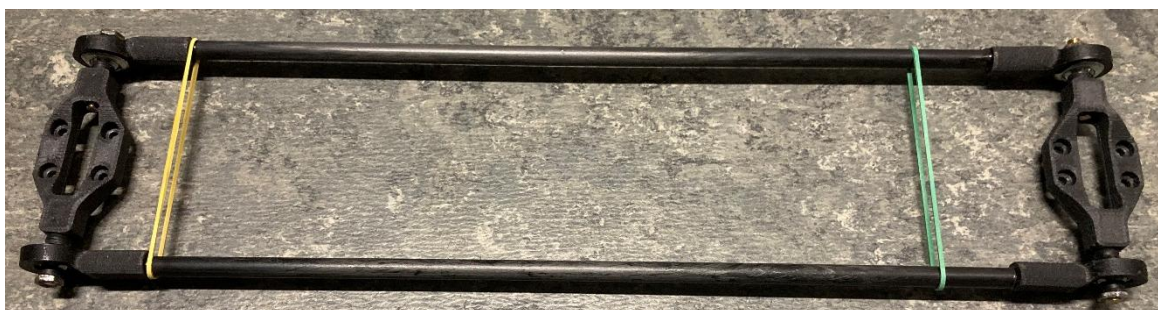
Obrázek 24: Sestava paralelogramu skládající se ze vzpěr a kloubů
