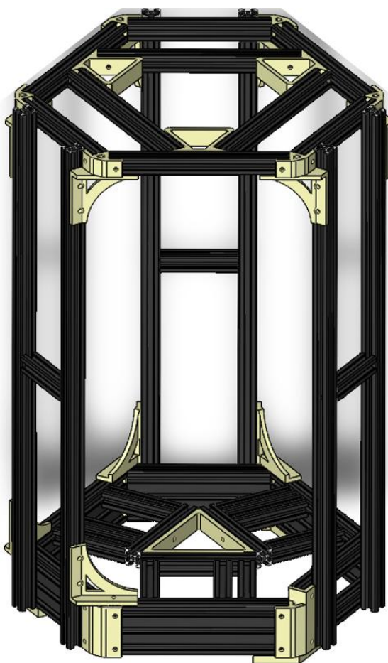
Obrázek 20: Ukázka kompletního rámu tiskárny sestavená v programu SolidWorks 2023
