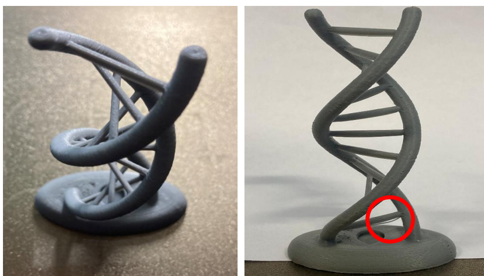
Obrázek 34: Ukázka testu chlazení a tisku převisů u dvojité šroubovice
