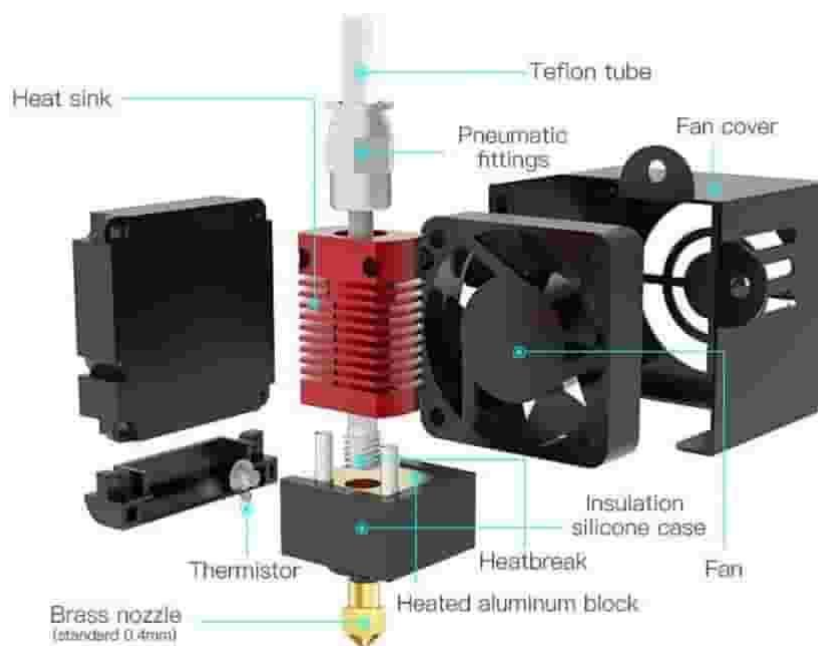
Obrázek 5: Ukázka konstrukce hotendu tiskárny Ender 3 [7]
