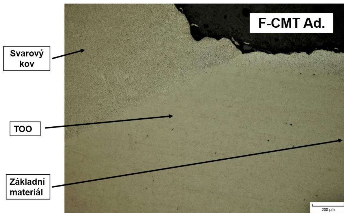
Obr. 55 Mikrostruktura vzorku F, zvětšení 100x.
