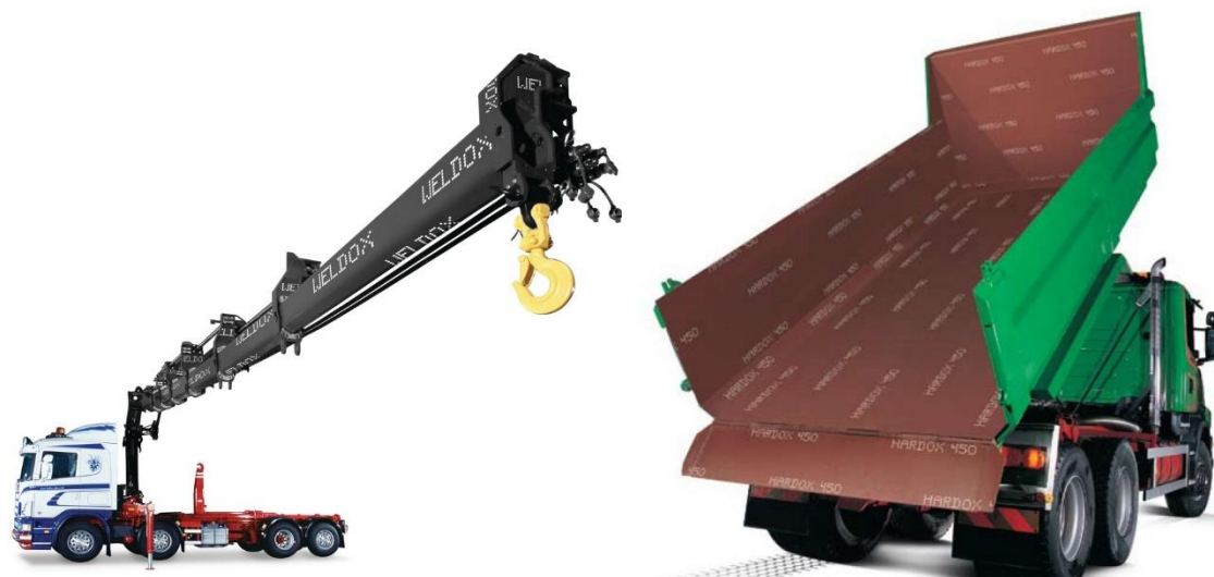
Obr. 1 Příklady použití oceli s vyšší pevností, vlevo rameno jeřábu z materiálu Weldox, vpravo korba nákladního automobilu z materiálu Hardox [2, 3].
