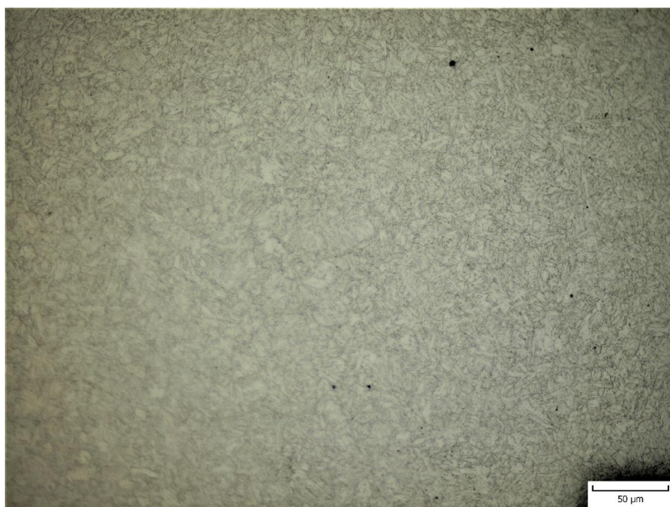
Obr. 62 Mikrostruktura základního materiálu vzorku H, zvětšení 400x.
