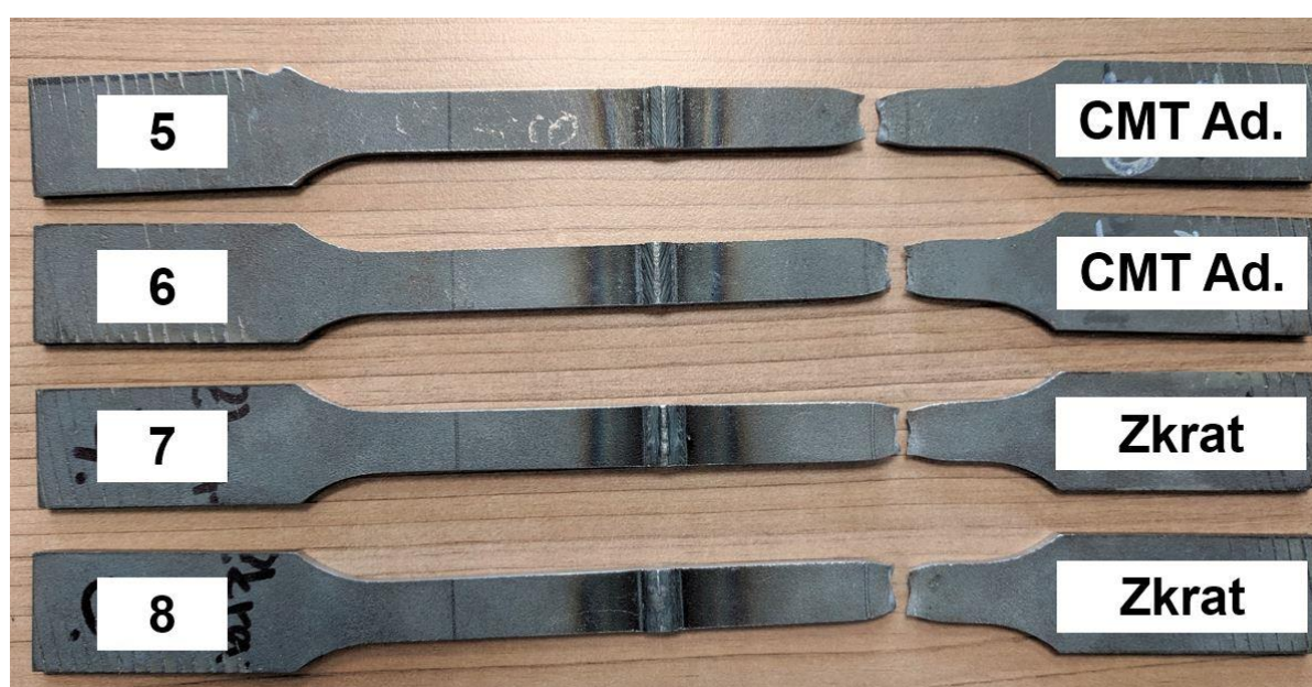
Obr. 39 Přetržené vzorky z materiálu Weldox.
