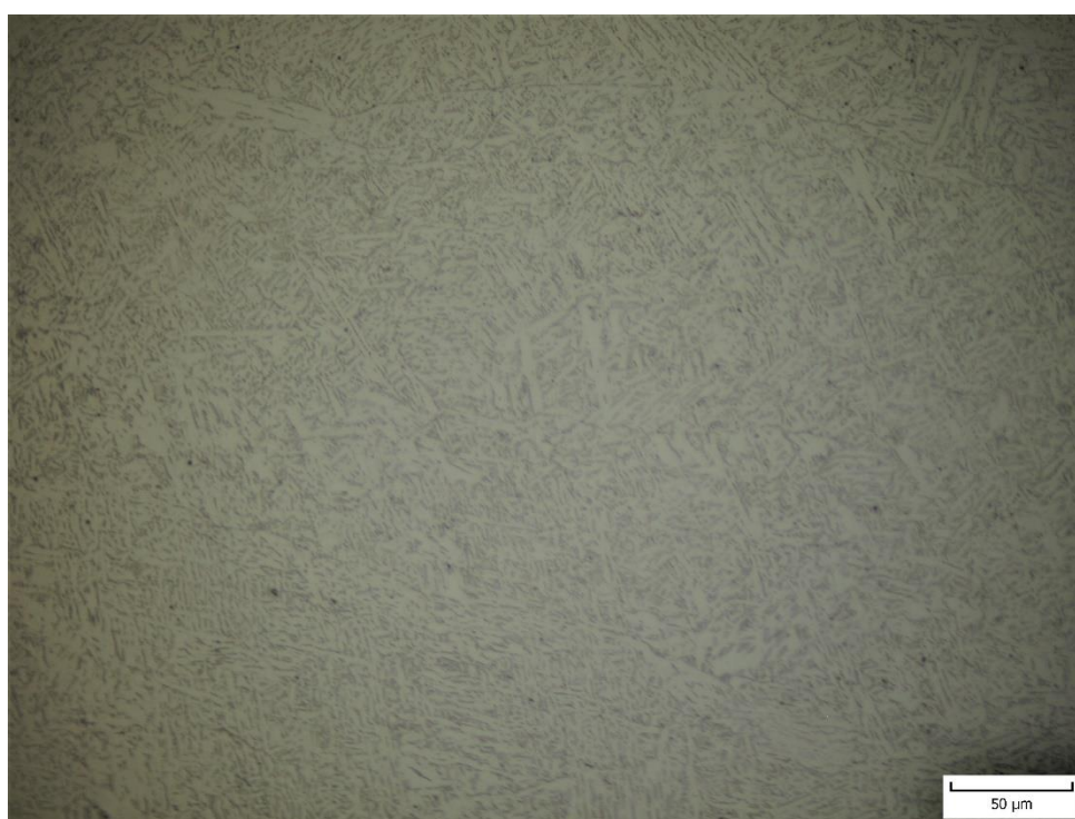
Obr. 60 Mikrostruktura svarového kovu vzorku H, zvětšení 400x.
