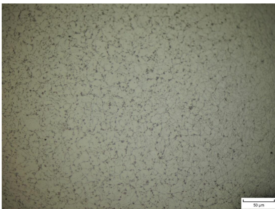
Obr. 54 Mikrostruktura základního materiálu vzorku D, zvětšení 400x.
