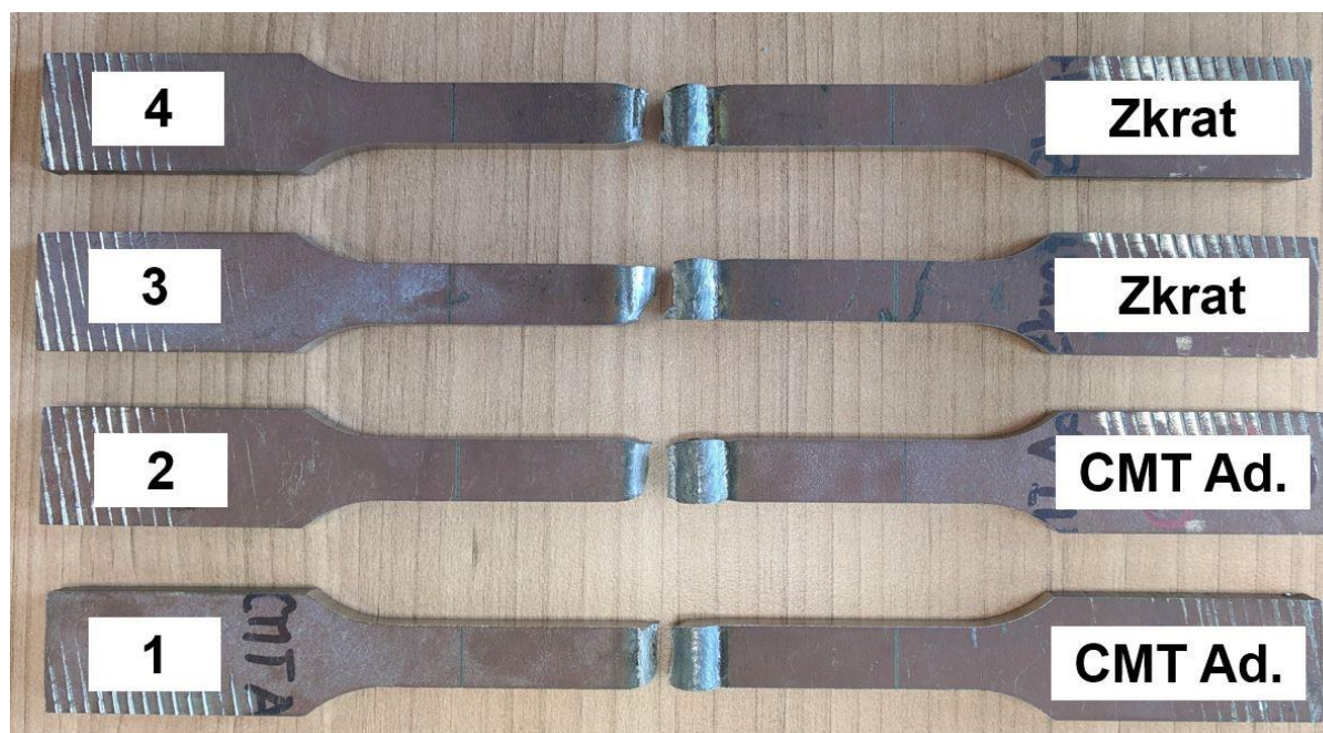
Obr. 31 Přetržené vzorky z materiálu Hardox.
