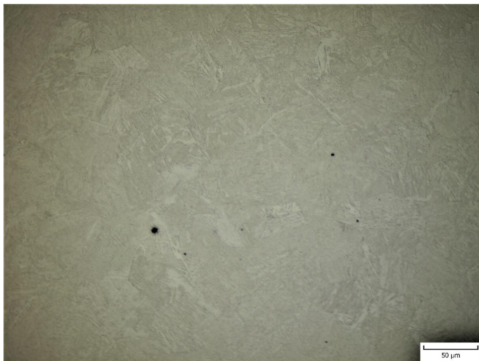
Obr. 61 Mikrostruktura TOO vzorku H, zvětšení 400x.
