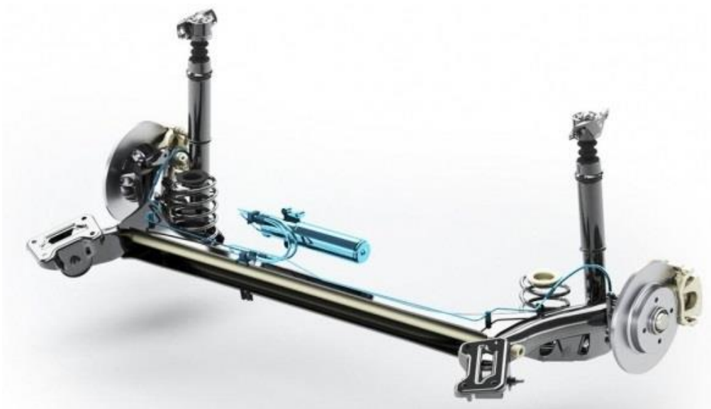
Obr. 4 Kliková náprava s torzně poddajným prvkom vozidla Peugeot 3008 [13]
