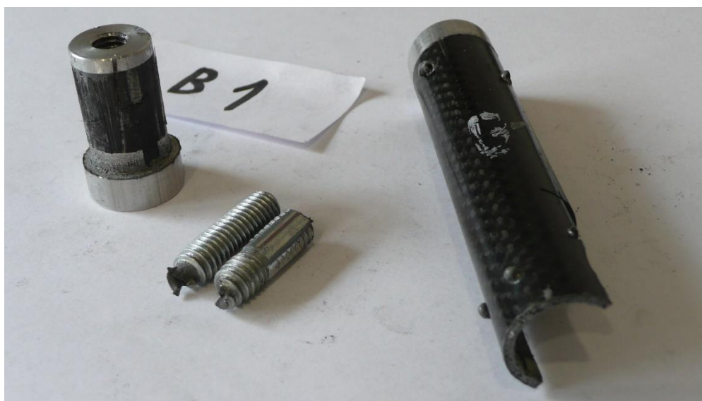
Obr. 26 Přetržený šroub M8 8.8 při testu vzorku B1
