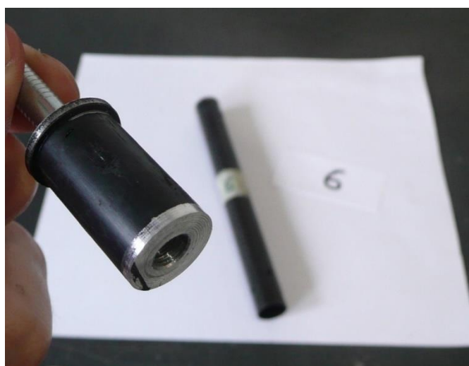
Obr. 15 Adhezivní porucha vzorku 6
