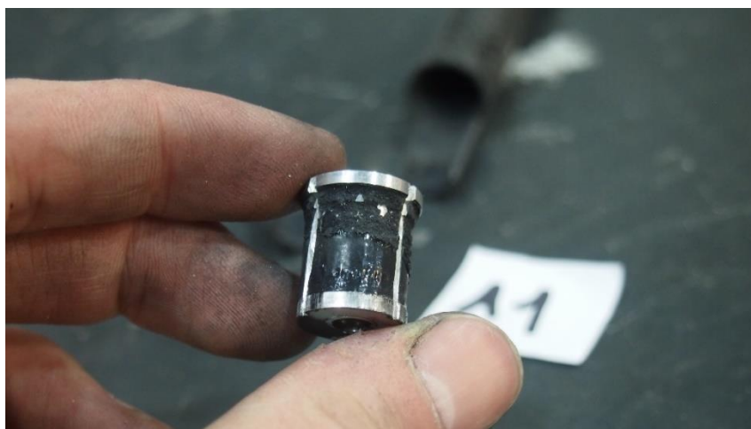
Obr. 17 Nedostatek lepidla na vzorku A1
