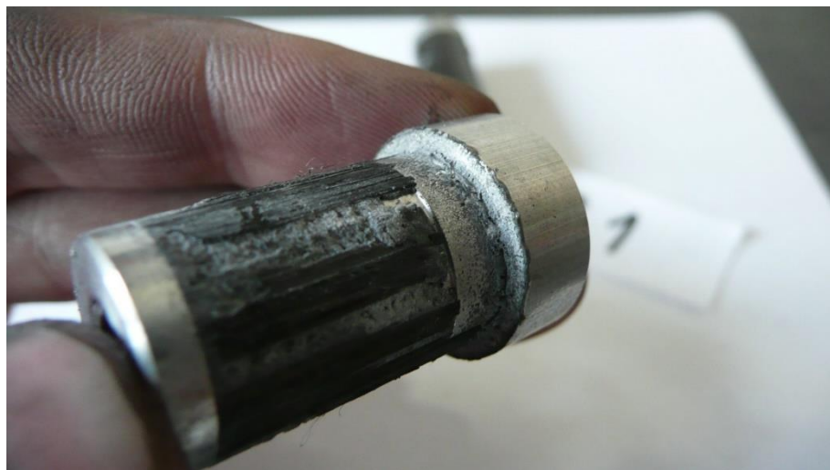
Obr. 22 Vytržená vlákna trubky na vzorku B1
