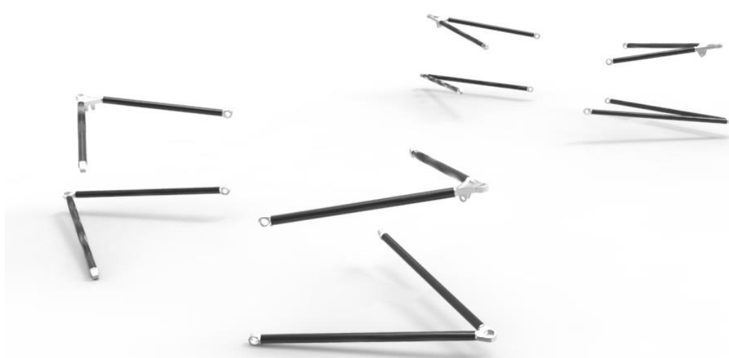
Obr. 27 Navržená sestava ramen zavěšení s vlepenými úchyty kloubů
