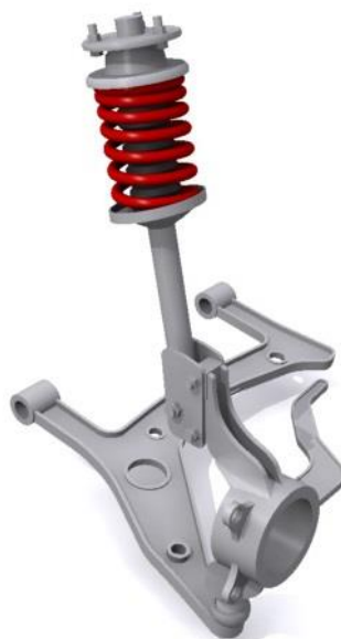
Obr. 3 Příklad přední nápravy McPherson [13]
