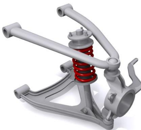
Obr. 2 Lichoběžníková náprava s trojúhelníkovými rameny[13]
