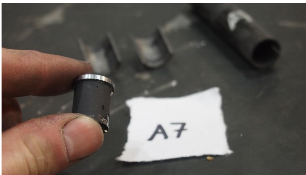
Obr. 19 Adhezni porucha u vzorku A7
