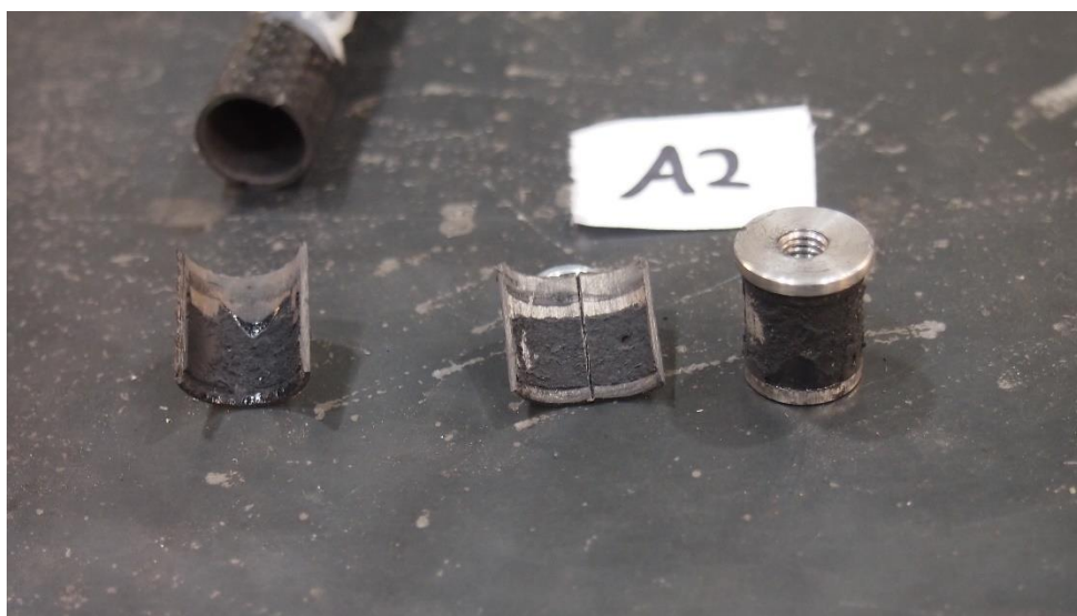
Obr. 18 Přibližně 60 % lepené plochy vzorku A2 bylo porušeno kohezní poruchou
