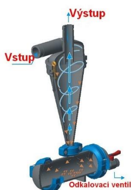
Obr. 3.4 Průběh proudění vody v hydrocyklonu [33]
