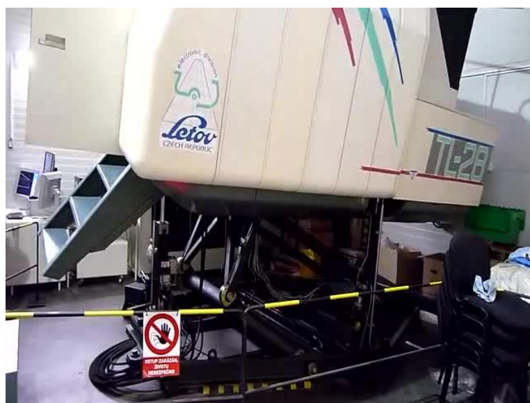
Obr. 4: Letecký plně pohyblivý simulátor [10]
