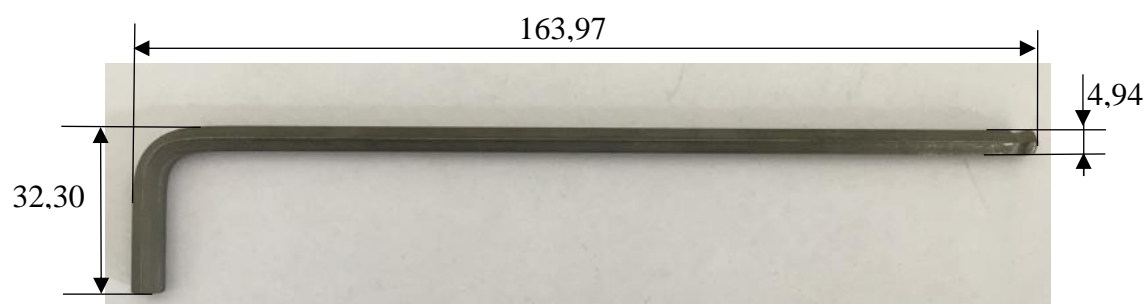
Obr. 45: Díl B1(imbusový klíč 5) s rozměry
