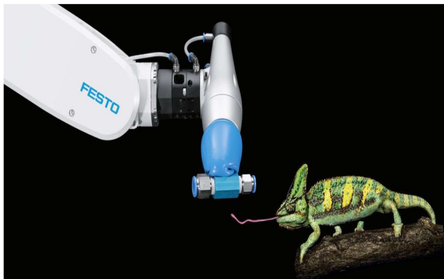
Obr. 22: Příklad efektoru inspirovaného chameleonem (Festo) [31]
