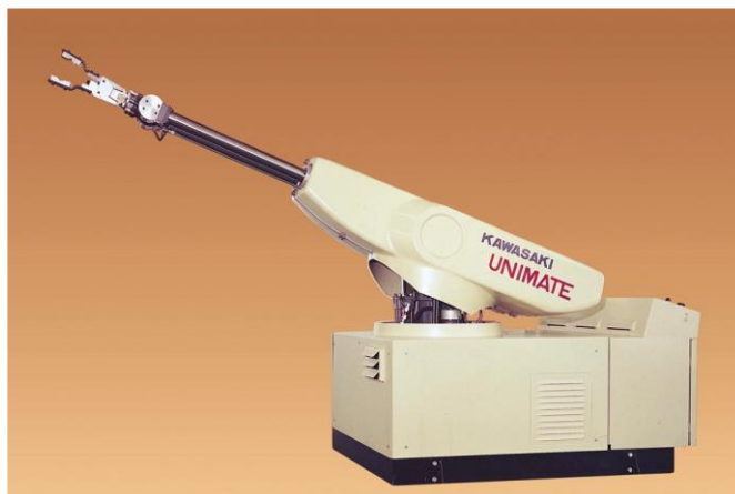
Obr. 13: Příklad sférického robota (Kawasaki) [18]
