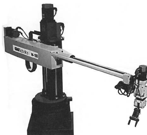
Obr. 12: Příklad cylindrického robota [17]
