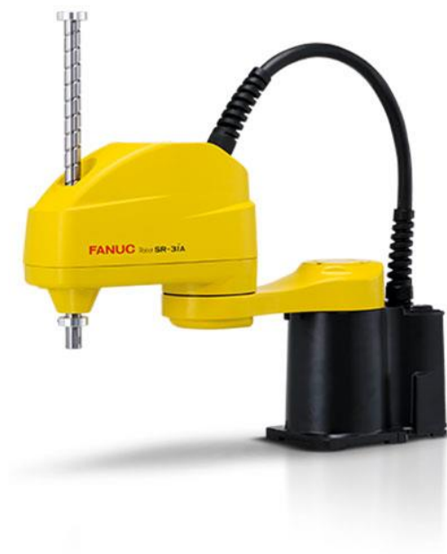
Obr. 15: Příklad SCARA robota (Fanuc) [20]
