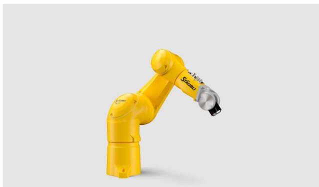
Obr. 16: Příklad 6-osého robota TX-90 (Fanuc) [21]
