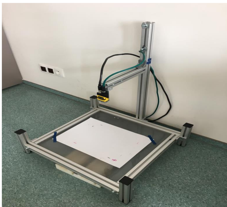
Obr. 25: Realizace finální verze snímacího pole (výškově nastavitelné snímací pole i kamerový držák)
