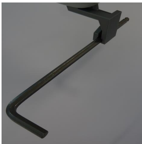
Obr. 63: Uchycení dílu B1 čelistmi
