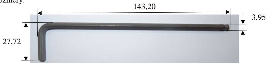
Obr. 46: Díl B2 (Imbusový klíč 4) s rozměry
