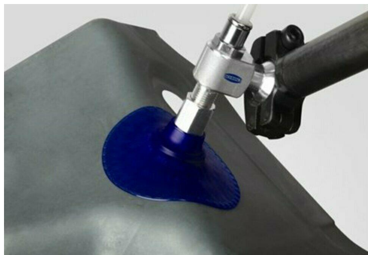
Obr. 21: Příklad podtlakového efektoru, savka (Schunk) [30]
