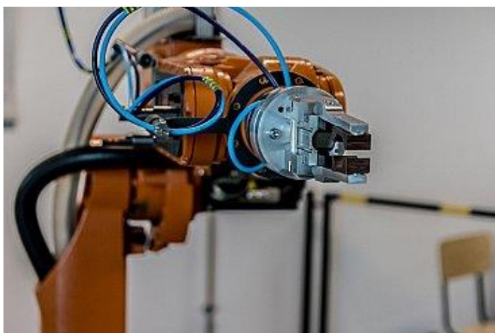
Obr. 19: Příklad pneumatického efektoru s průmyslovým robotem [28]
