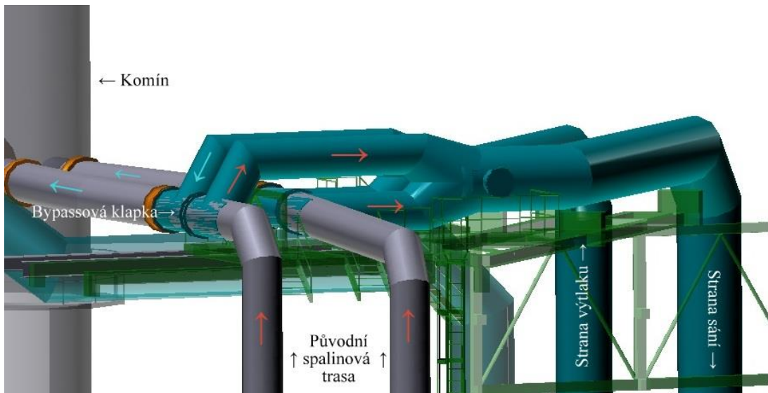
Obr. 49 Model vstupu do potrubní trasy kondenzační jednotky
