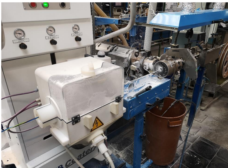
Obrázek 6: Proces nanášení klouzku a izolačního materiálu
