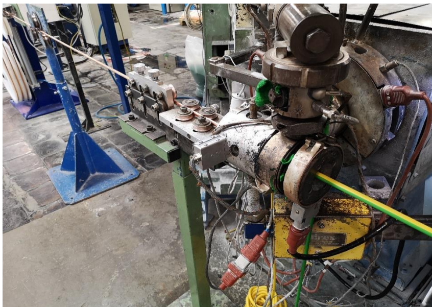
Obrázek 7: Proces plášťování lanového zemního vodiče
