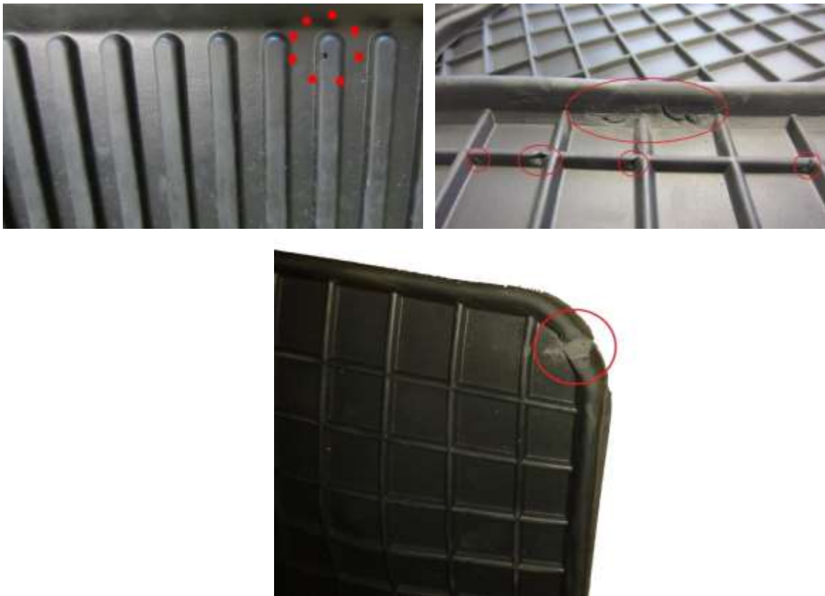
Obr. 6 Zmetkové autokoberce obsahující nedolítky
