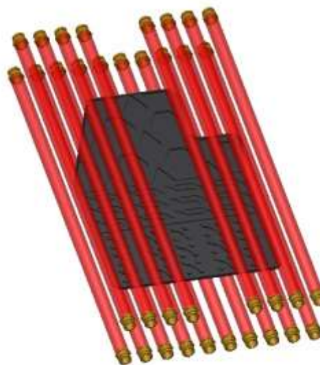
Obr. 25 Poloha temperačního systému vůči výstřiku
