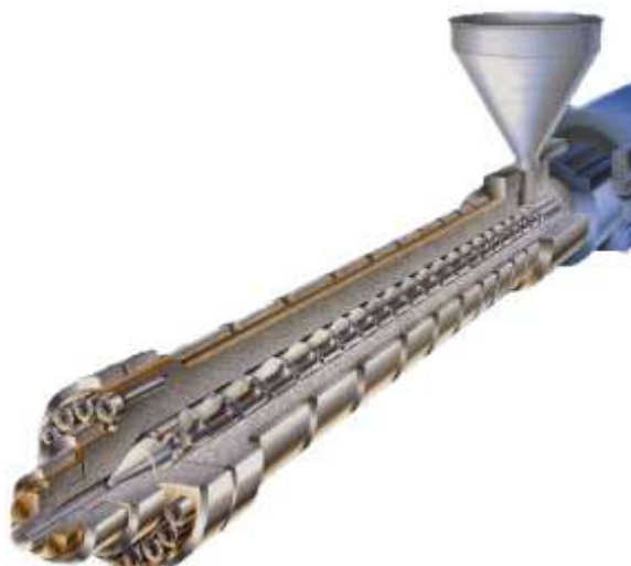
Obr. 15 Řez šnekovou vstříkací jednotkou [9]
