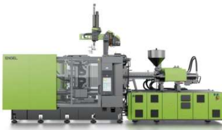
Obr. 27 Vstřikovací stroj ENGEL Duo 16050/1300 Advanced [13]
