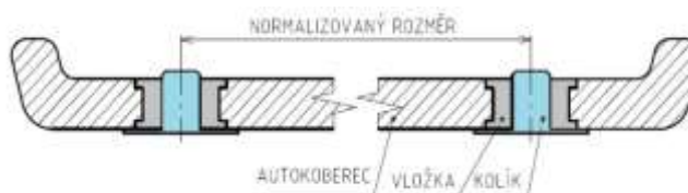
Obr. 3 Upínací systém autokoberce
