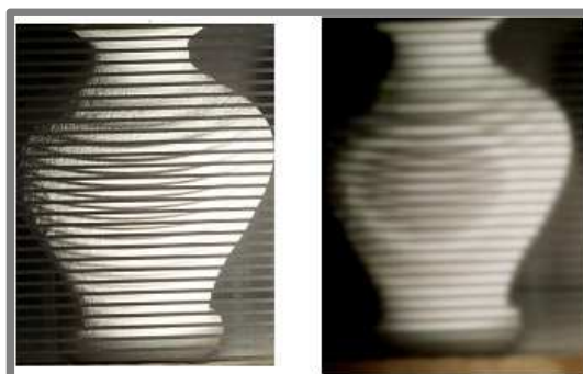
Obr. 1-10 Příklad skenování s využitím Moiré efektu [2]
