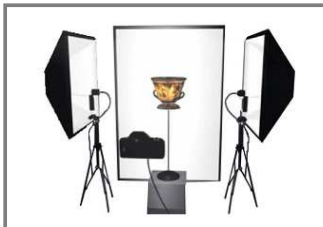
Obr. 1-6 Příklad skenování s využitím siluety [1]
