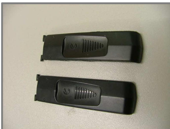
Obr. 5-16 Kryt bateriového prostoru; originál dole, kopie nahoře
