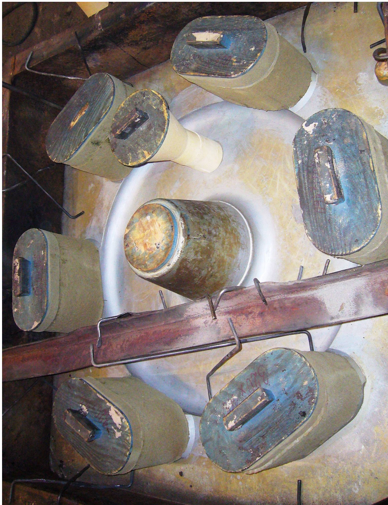
Obr.4.2.1: Modelové zařízení vršku formy s izolací pro nálitky.
