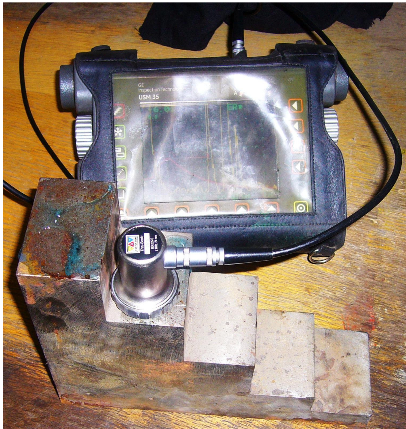
Obr.4.2.7: Kontrola nastavení UZ na stupňovitém etalonu.
