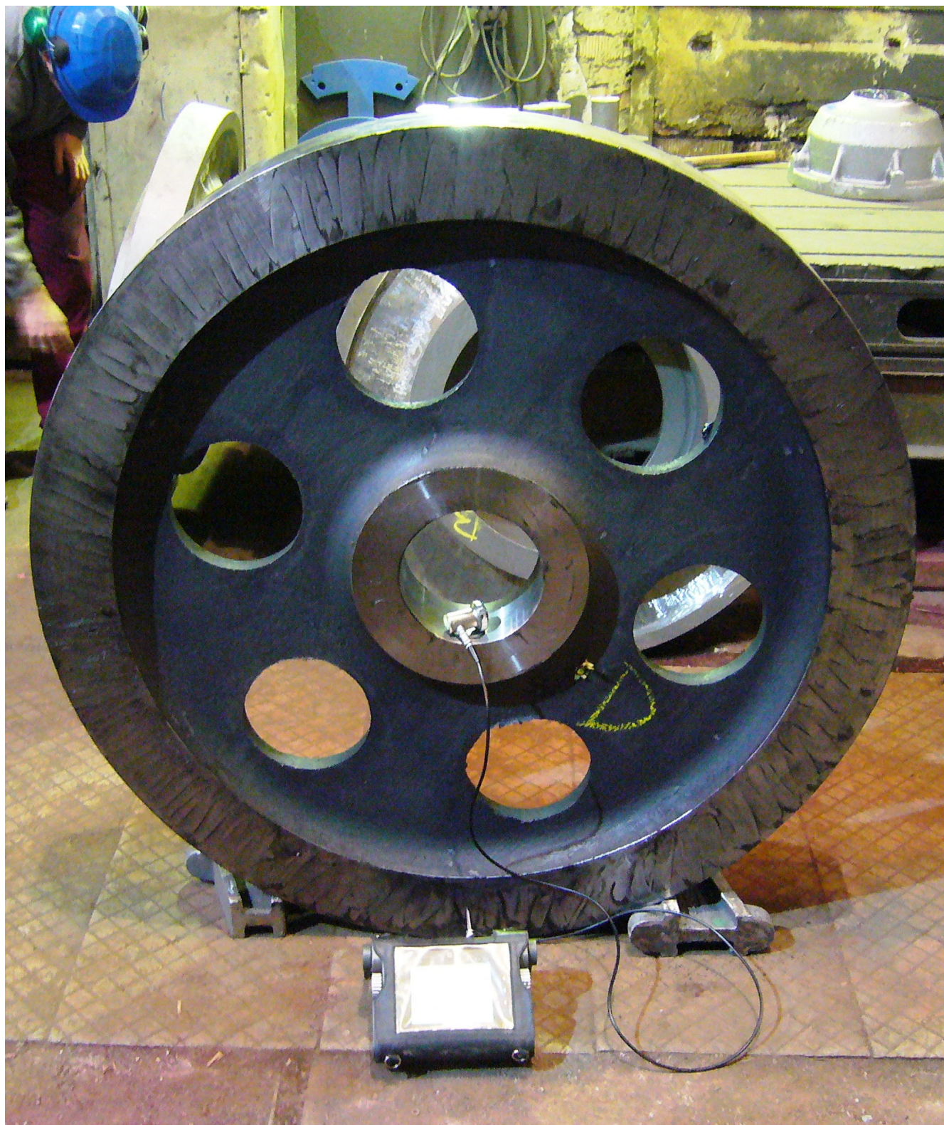
Obr.4.3.2.1: Zkoušení sledovaného odlitku ultrazvukem.
