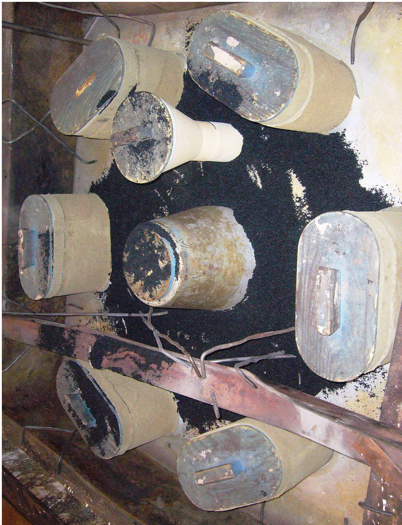
Obr.4.2.3: Zасыпání vršku formy chromitovou směsí v oblasti tepelných uzlů.
