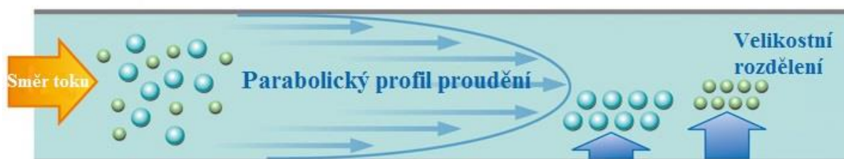
Obr. 10 - Separační kanálek s laminárním prouděním [24]
