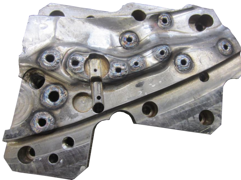
Obr. 26 Renovace opotřebovaného povrchu součásti navařováním.
