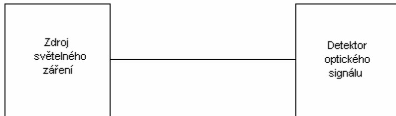
Obr. 8.1: Měření referenční hodnoty P_{ref}
