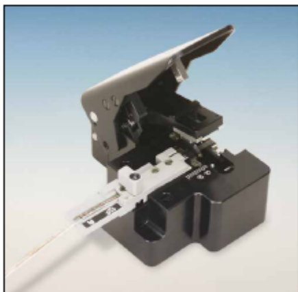
Obr. 8.8: a) Lámačka S46999-M9-D12 b) Lámačka FITEL S325A
