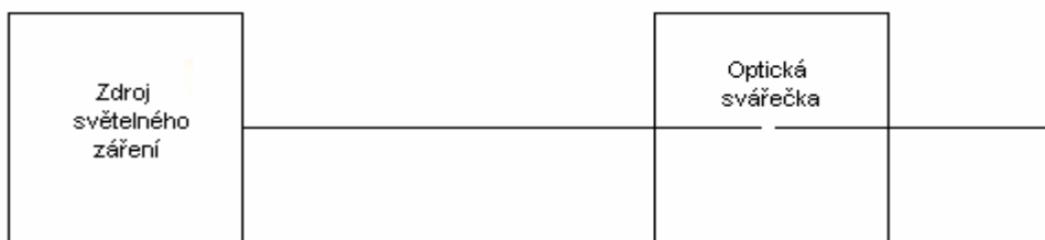
Obr. 8.7: Zapojení pro měření útlumu sváru
