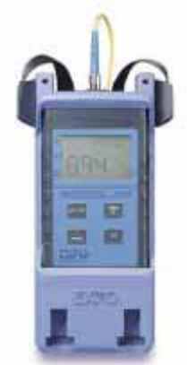
Obr. 8.4: Detektor optické signálu Fiberoptics Tester FOT-20A
