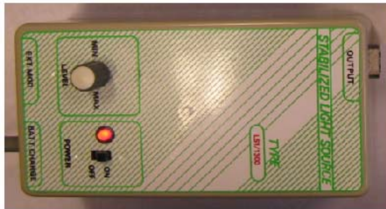
Obr. 8.3: Zdroj světelného záření Stabilized Light Source
