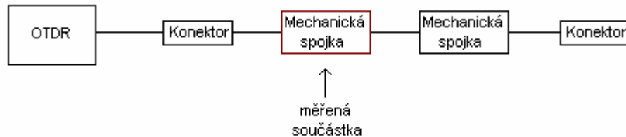
Obr. 8.9: Schéma pro měření mechanické spojky metodou OTDR
