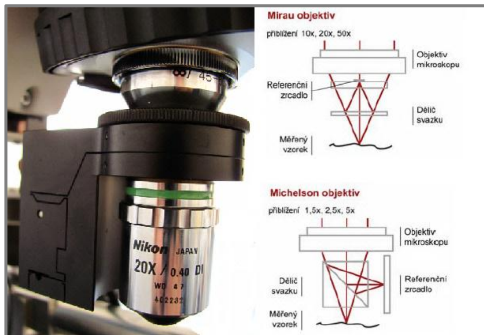
Obr. 31 Mirau interferenční objektiv s piezoelektrickým posuvem [27].
