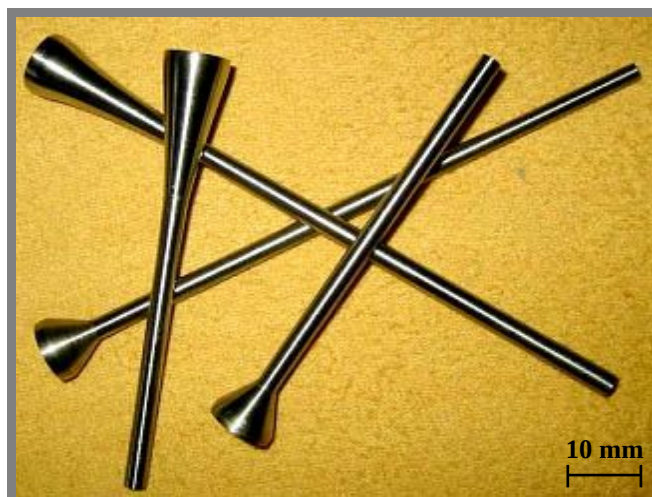
Obr. 1.7-2 Vlnovody – hyperbolické a kuželové [21]
