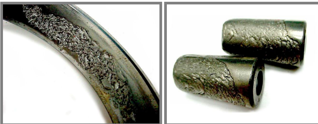
Obr. 1.3-2 Pitting na kroužku ložiska a valivém tělese ve velmi pokročilém stádiu [7]
