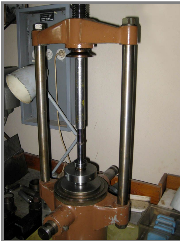
Obr. 7.1-2 Nalisování ložisek na hřídel
