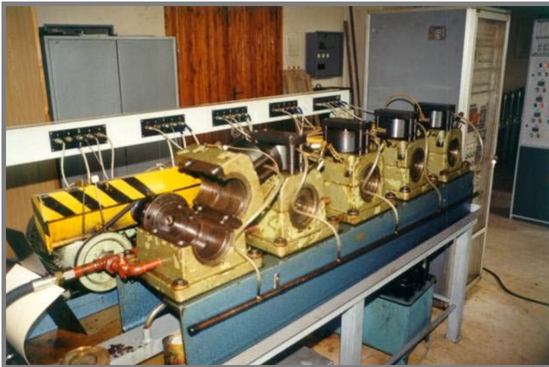
Obr. 1.8-2 ZKL - Zkušební zařízení trvanlivosti radiálních ložisek s konstantním zatěžováním [25]
