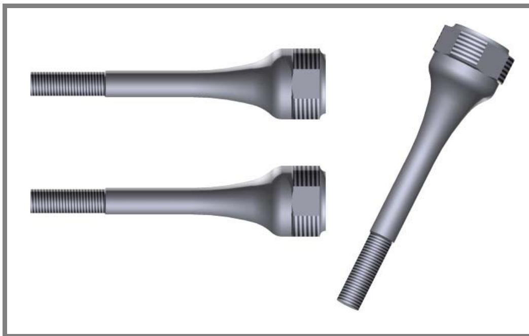
Obr. 6-7 Upravený vlnovod DAKEL – 3D model
