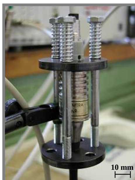
Obr. 1.7-4 Speciální uchycení vlnovodu [21]
