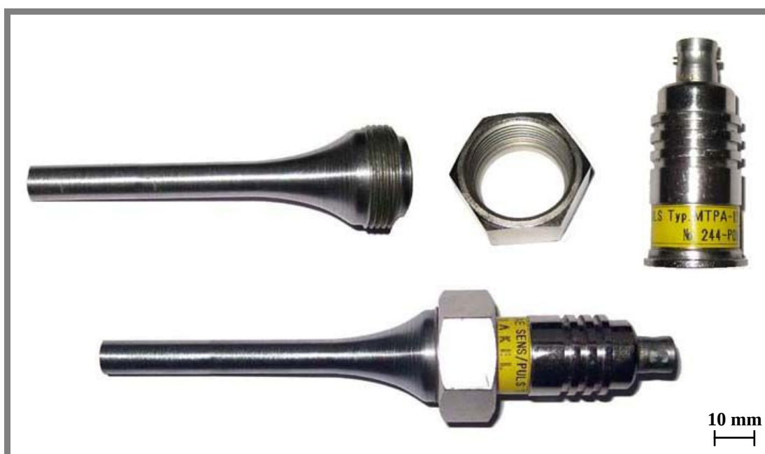
Obr. 5.2-1 Snímač DAKEL MTPA-15 s vlnovodem a převlečnou maticí
