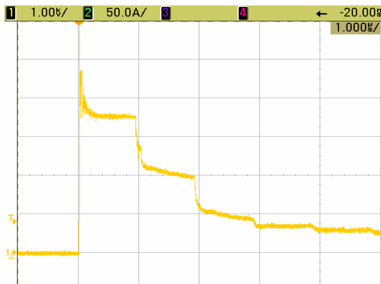
obr.6.7 Napěťový impuls na poškozené zátěži
