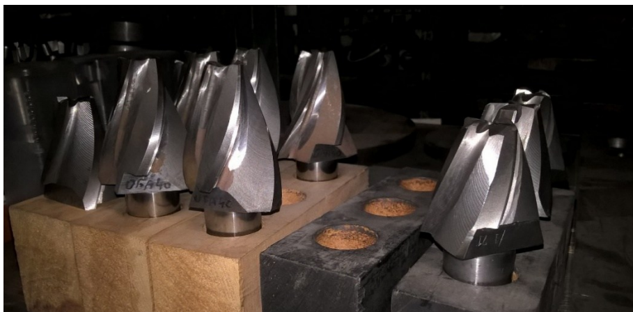
Obr. 21 Hlavové a patní frézy uložené ve skladu nástrojů.
