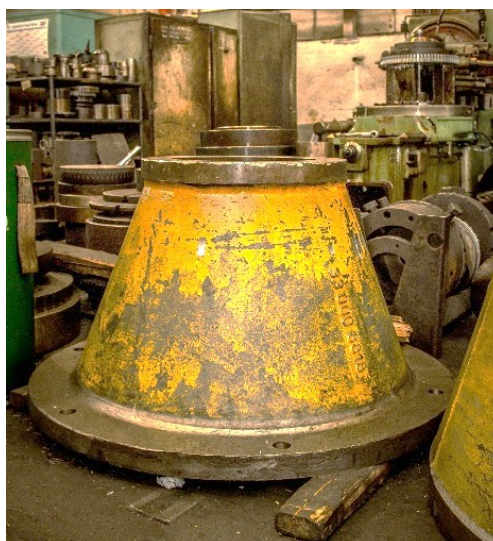
Obr. 22 Upínací přípravek OFA 40/973.
