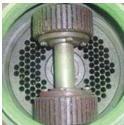
Obr. 1.9. Matrice peletovacího lisu s přítlačnými rolnami [18], které zpracovávaný materiál protlačují otvory v matici. Velikost otvorů v matici udává konečný rozměr pelet
