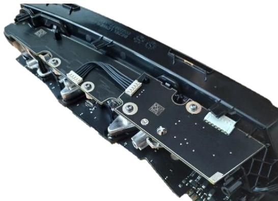
Obr. 6 Uchycení desek plošných spojů samořeznými šrouby k reflektoru [1].
