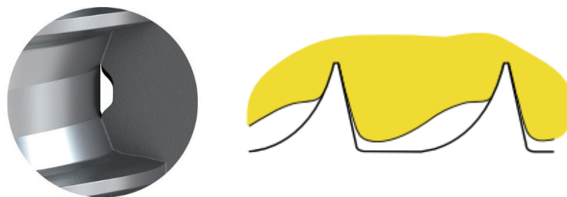
Obr. 17 Tok materiálu závitotvornými šrouby [20; 23].
