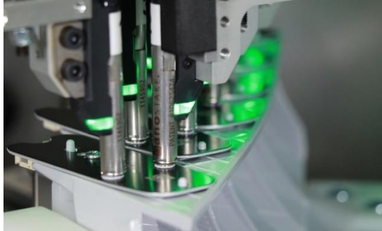
Obr. 5 Aplikace tavných pinů na uchycení desek plošných spojů tavnými piny [8].
