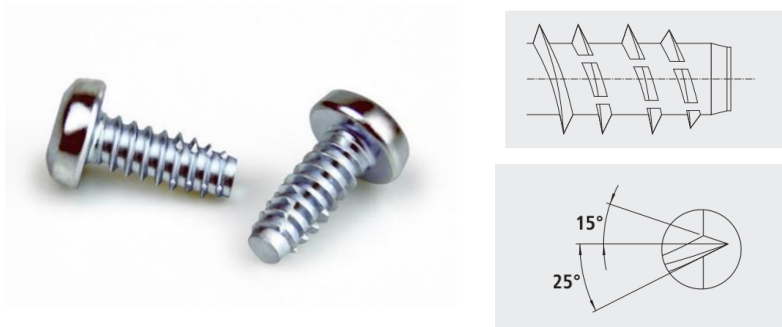
Obr. 22 Šroub IBI-ZAS a profil závitu [29].
