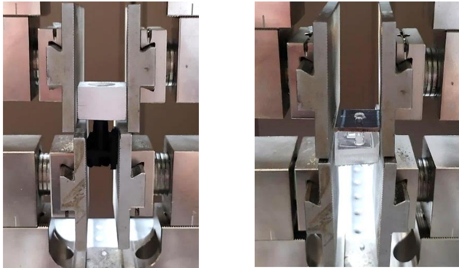
Obr. 32 Uchycení vzorků šroubů a tavných pinů ve zkušebním zařízení (vlevo šroubový spoj, vpravo tavný pin).
