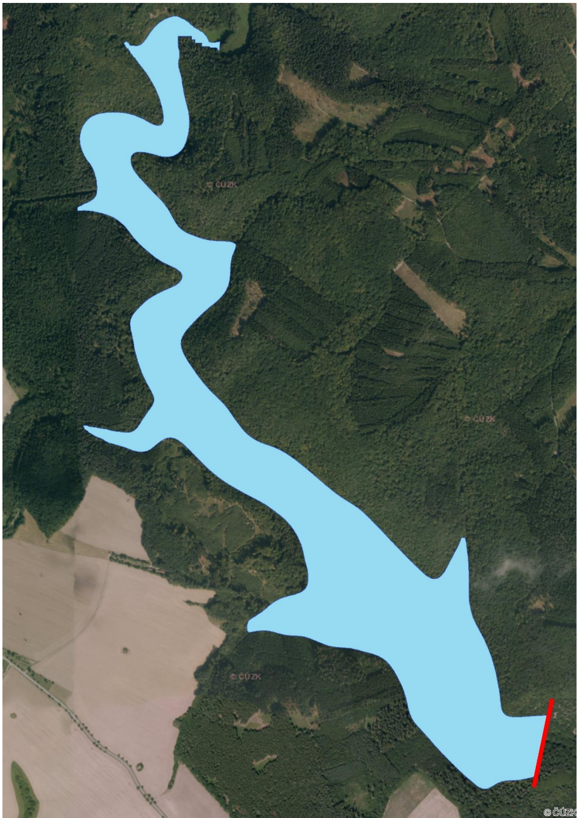
Obr. č. 28: Zatopená plocha při maximální hladině 339,0 m n.m. (mapový podklad ČÚZK)
