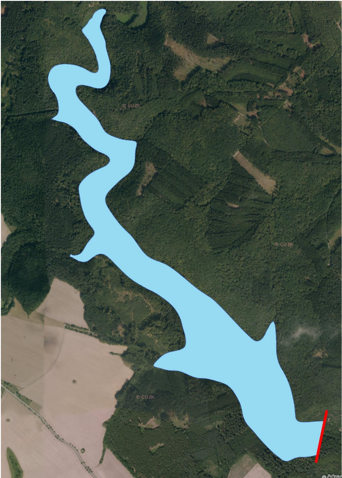
Obr. č. 27: Zatopená plocha při maximální hladině 337,0 m n.m. (mapový podklad ČÚZK)
