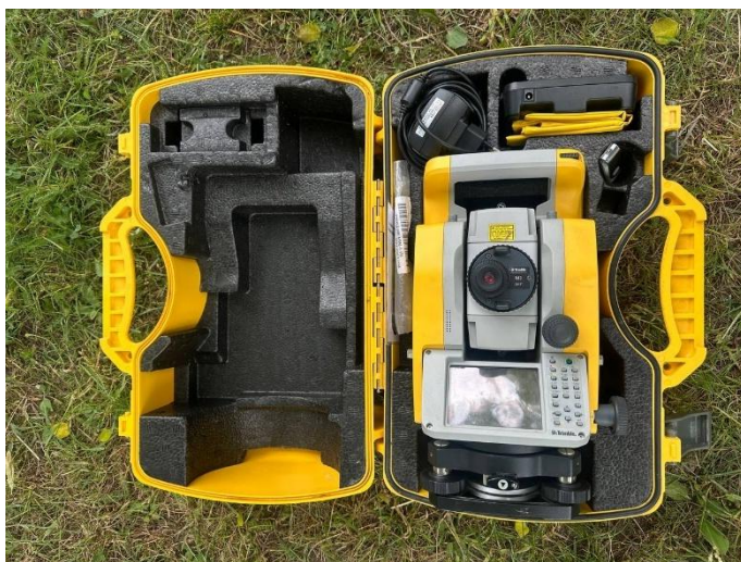
Obr. 5 - Totální stanice Trimble M3
