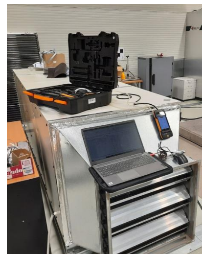
Obr. 12. 5, 6: Pohled do ventilátorové komory po instalaci náběhových plechů s důkladným utěsněním a vyhlazením styku náběhového plechu a ventilátorové komory, pohled na měření.
