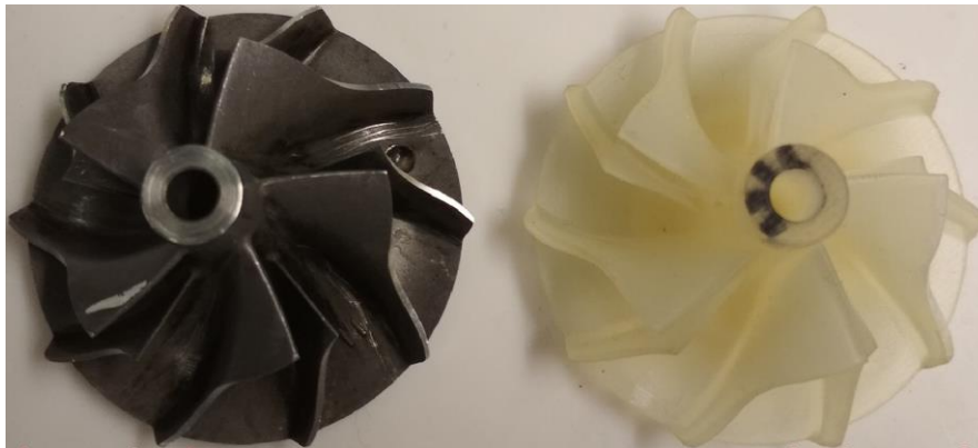
Obr. 1.9: Vlevo originální hliníkové kolo kompresoru a vpravo polymerové kolo [21].
