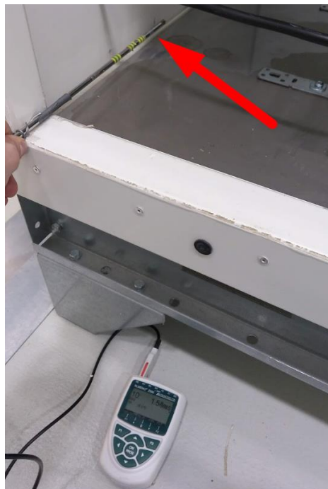
Obr. 5.7, 5.8: Umístění anemometru a schéma bodů ventilátorové komory, u kterých byla měřena rychlost proudění vzduchu při konstantním průtoku a nastavené frekvenci frekvenčního měniče.
