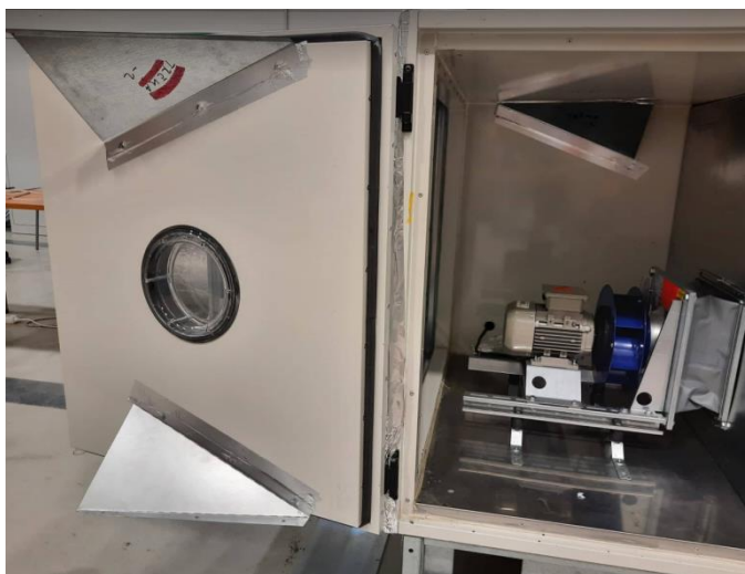
Obr. 12. 5, 6: Pohled do ventilátorové komory po instalaci náběhových plechů s důkladným utěsněním a vyhlazením styku náběhového plechu a ventilátorové komory, pohled na měření.
