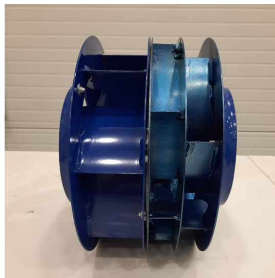
Obr. 12. 9, 10: Pohled ventilátorovou komoru a inovativní dvouřadé kolo.
