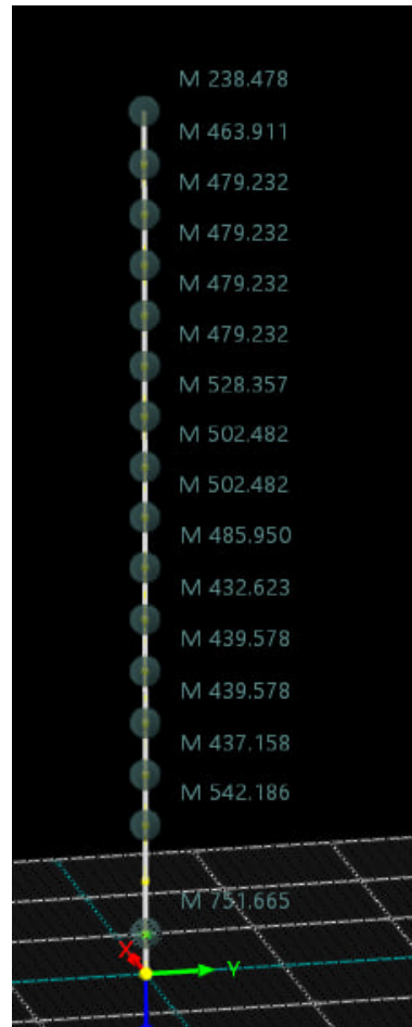
Obr. 2.15: Hmoty v uzlech v 1D RFEM modelu
