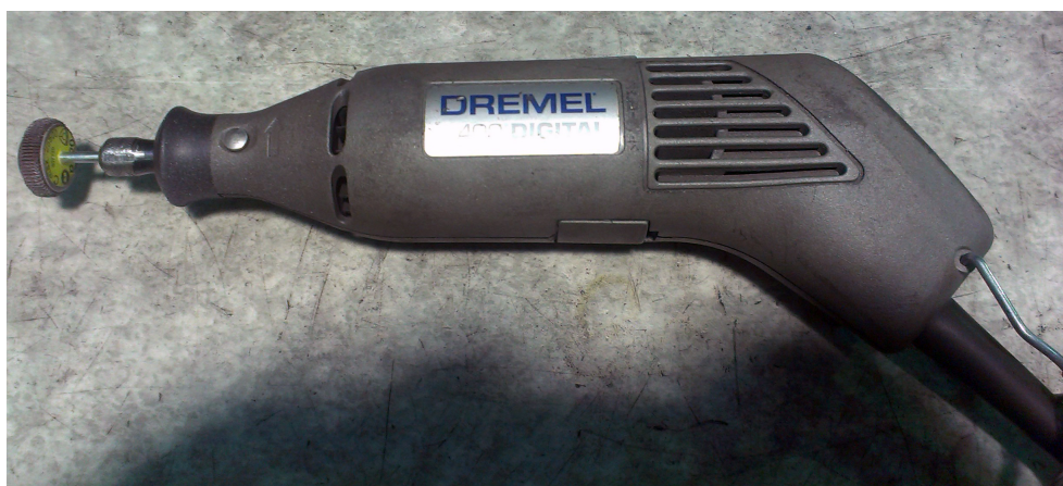
Obr. 3.16: Bruska Dremel 400 Digital – zdroj rušení
