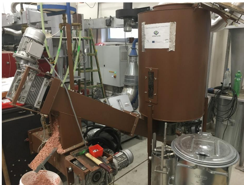
Obrázek 16 - Šnekový dopravník se zásobníkem, určený pro přepravu pilin na energetickém ústavu
