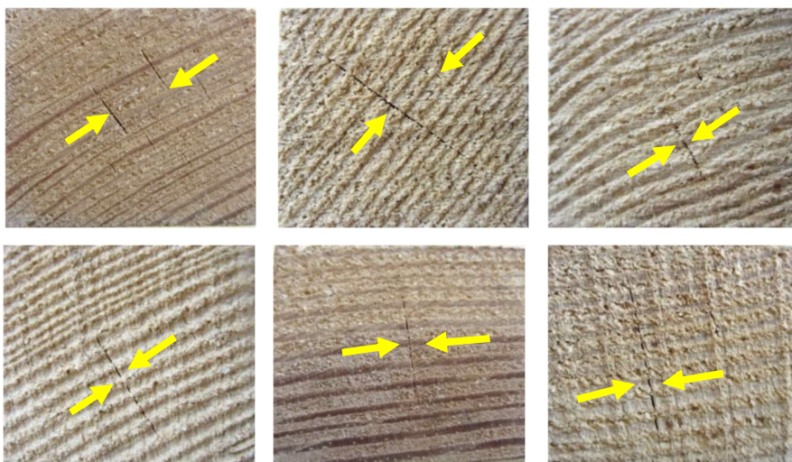
Obr. 25: Poškození v kolmém směru na vlákna.
