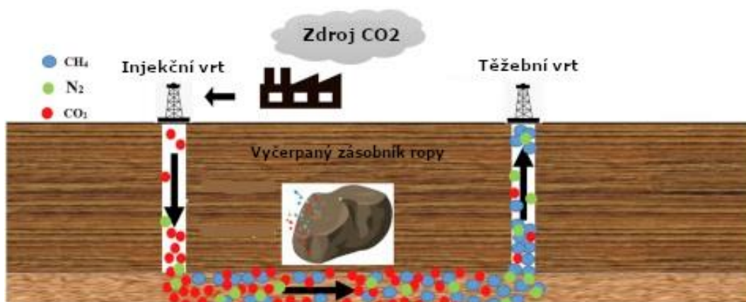
Obr. 4.5 Terciální metoda těžby ropy, upraveno dle [32]
