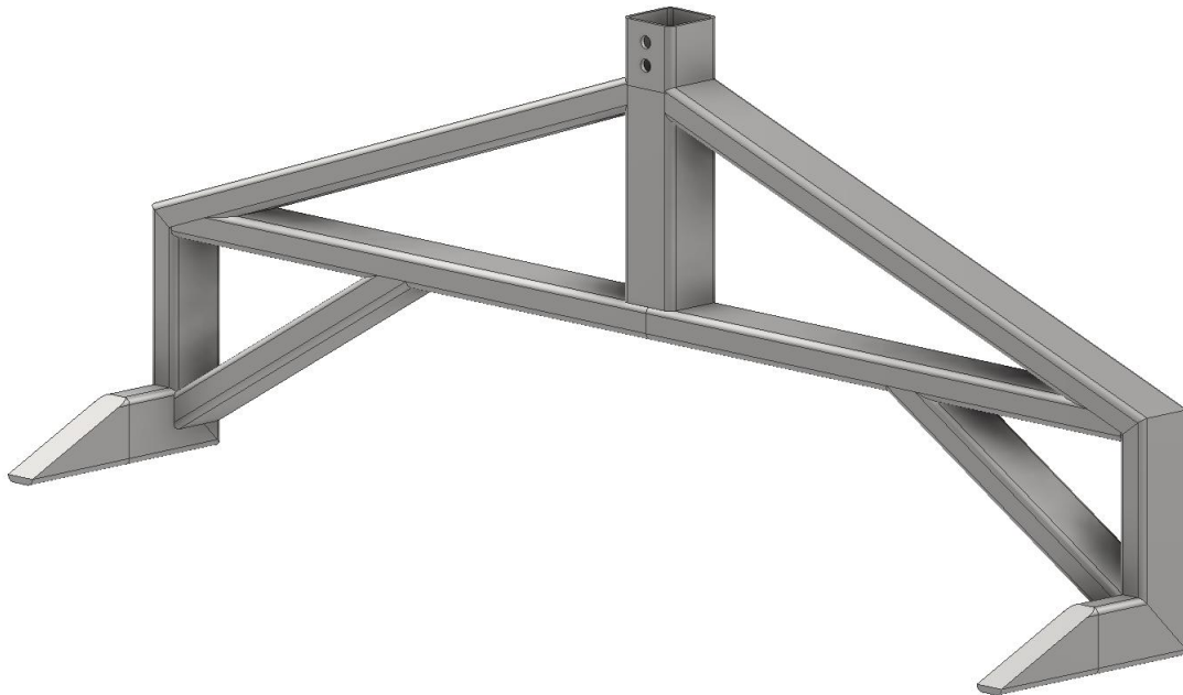
Obr. 16 Konštrukcia nakladacích vidlíc
