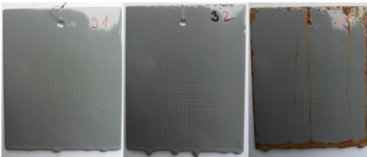
Obr. 31 Nátěrový systém č. 4: vzorky v pořadí – standard, po 240 h a po 480 h expozice
