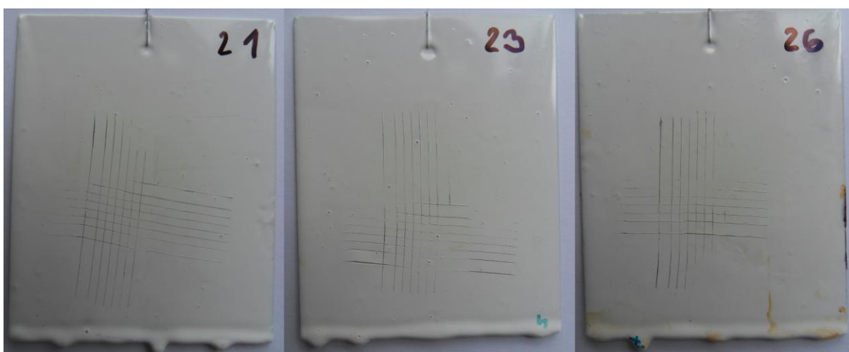
Obr. 30 Nátěrový systém č. 3: vzorky v pořadí – standard, po 240 h a po 480 h expozice
