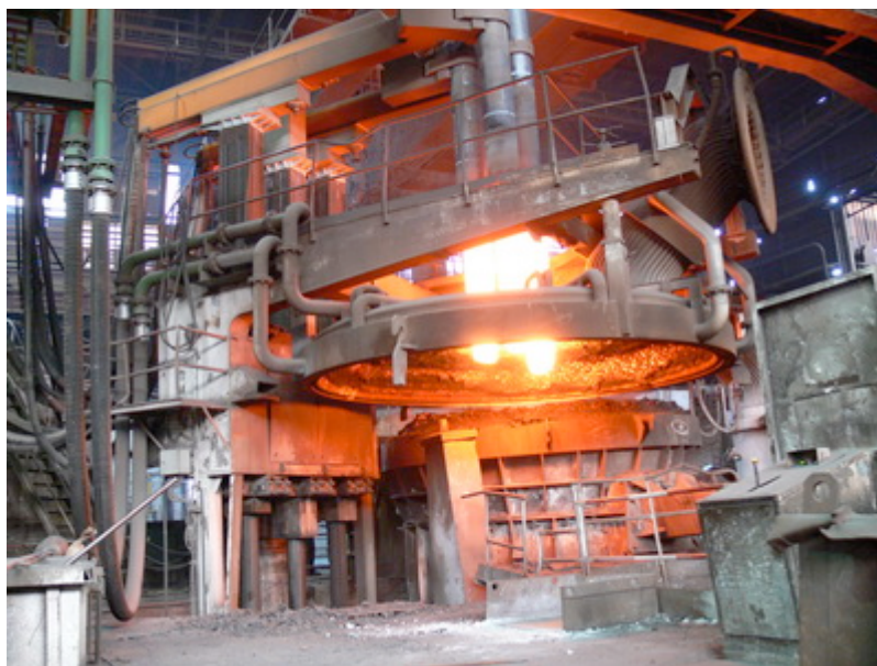
Obr. 1.5 Elektrická oblouková pec 25 t v ocelárně Poldi Hütte, Kladno. Grafitové elektrody a klenba pece jsou zdviženy před nasazením nové vsázky.
